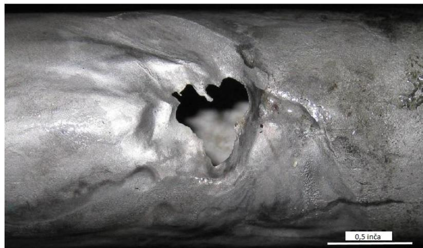
Slika 9: Rupa na cijevi izvana prema unutra na liniji za uzorkovanje oleuma<sup>10</sup> [10].
