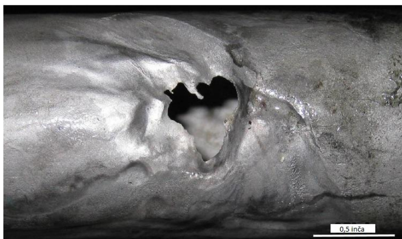
Slika 9: Rupa na cijevi izvana prema unutra na liniji za uzorkovanje oleuma 10 [10].
