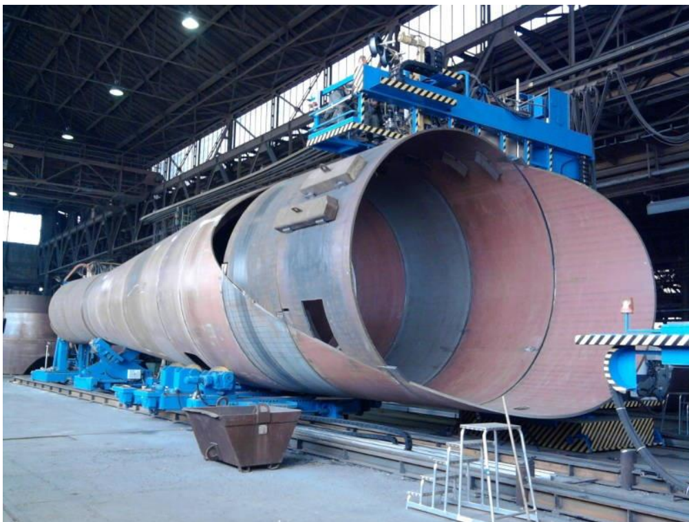
Slika 24 Postrojenje za zavarivanje cijevi [27]
