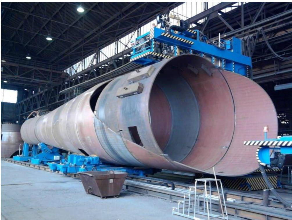
Slika 24 Postrojenje za zavarivanje cijevi [27]
