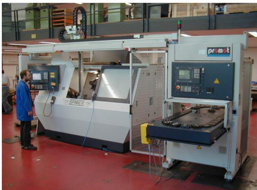
Slika 13 Horizontalna tokarska obradna ćelija [17]
