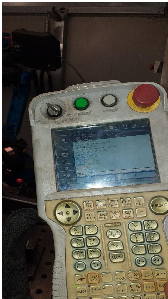
Slika 34. Džojstik za ručno programiranje [17]
