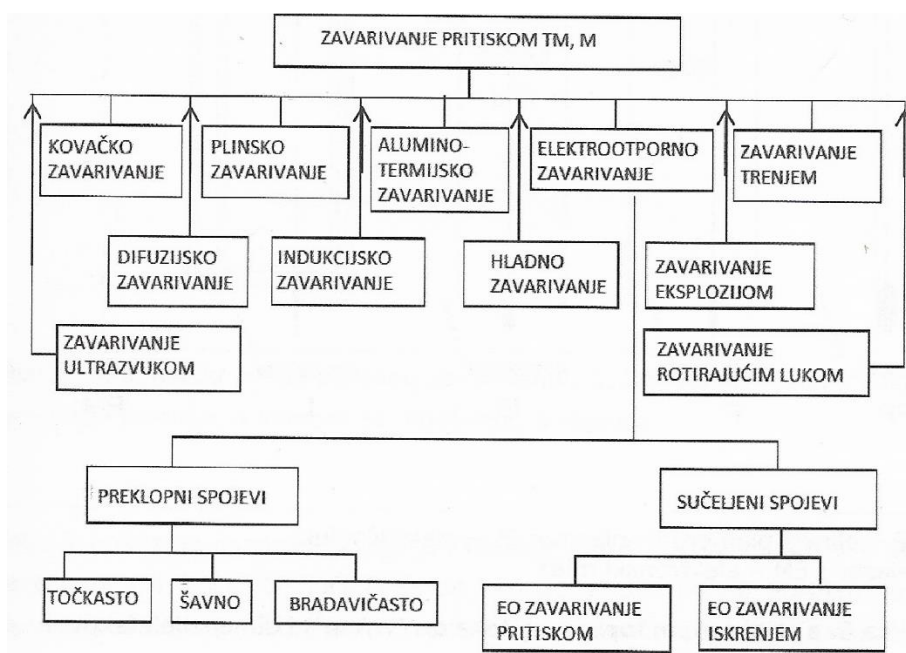
Slika 2. Podjela postupaka zavarivanja pritiskom [6]
