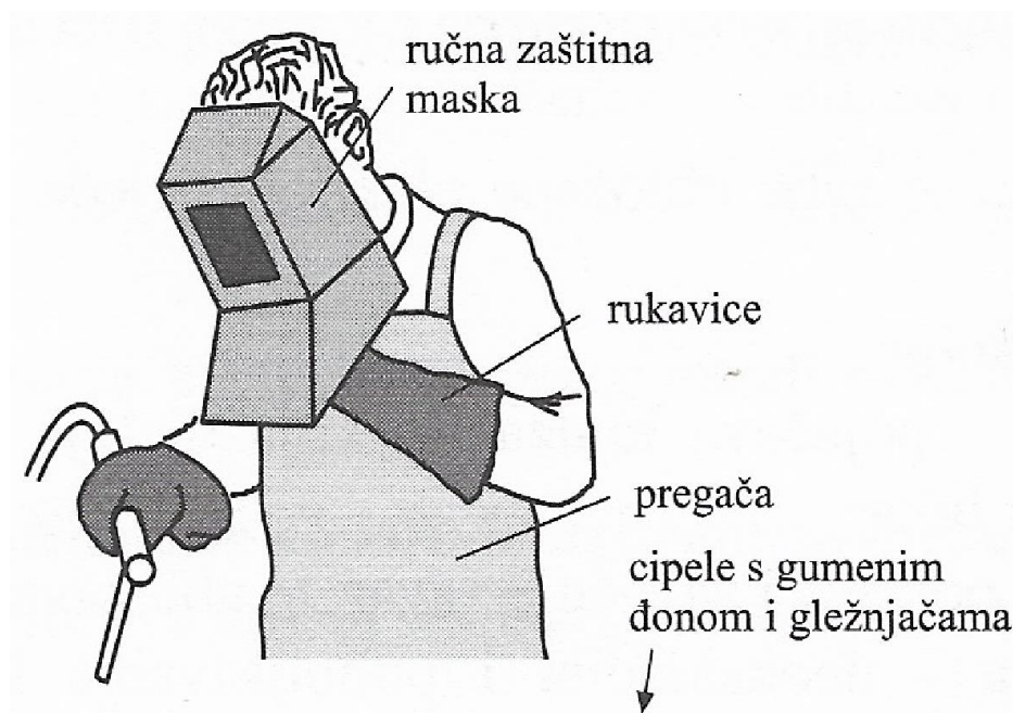
Slika 9. Zaštitna sredstva za rad pri zavarivanju [2]
