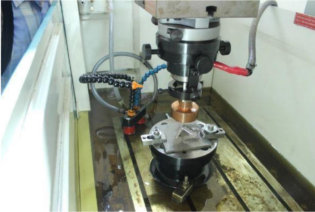
Slika 7 Primjer radnog stola za elektroeroziju žigom [8]
