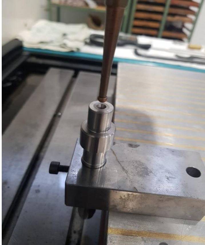
Slika 42 Pozicioniranje ticala u središte vratila
