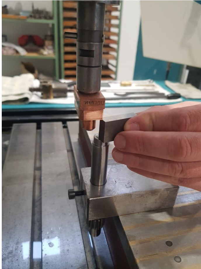
Slika 59 Uzimanje visine erodiranja pomoću etalona
