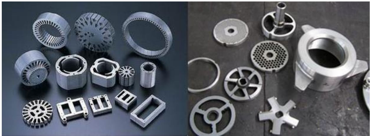
Slika 14 Proizvodi dobiveni elektroerozijom žicom [15]
