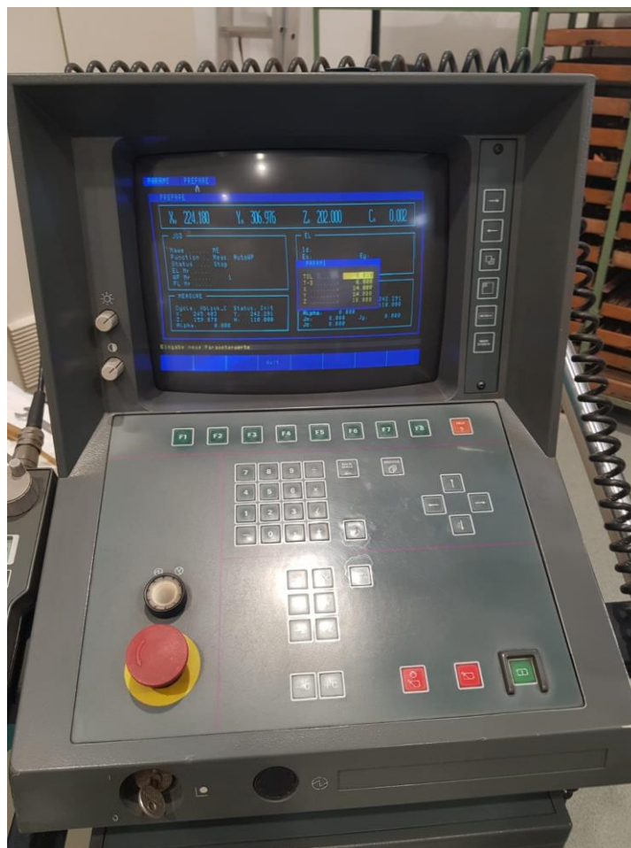
Slika 43 Izgled sučelja i tipkovnice za unos podataka
