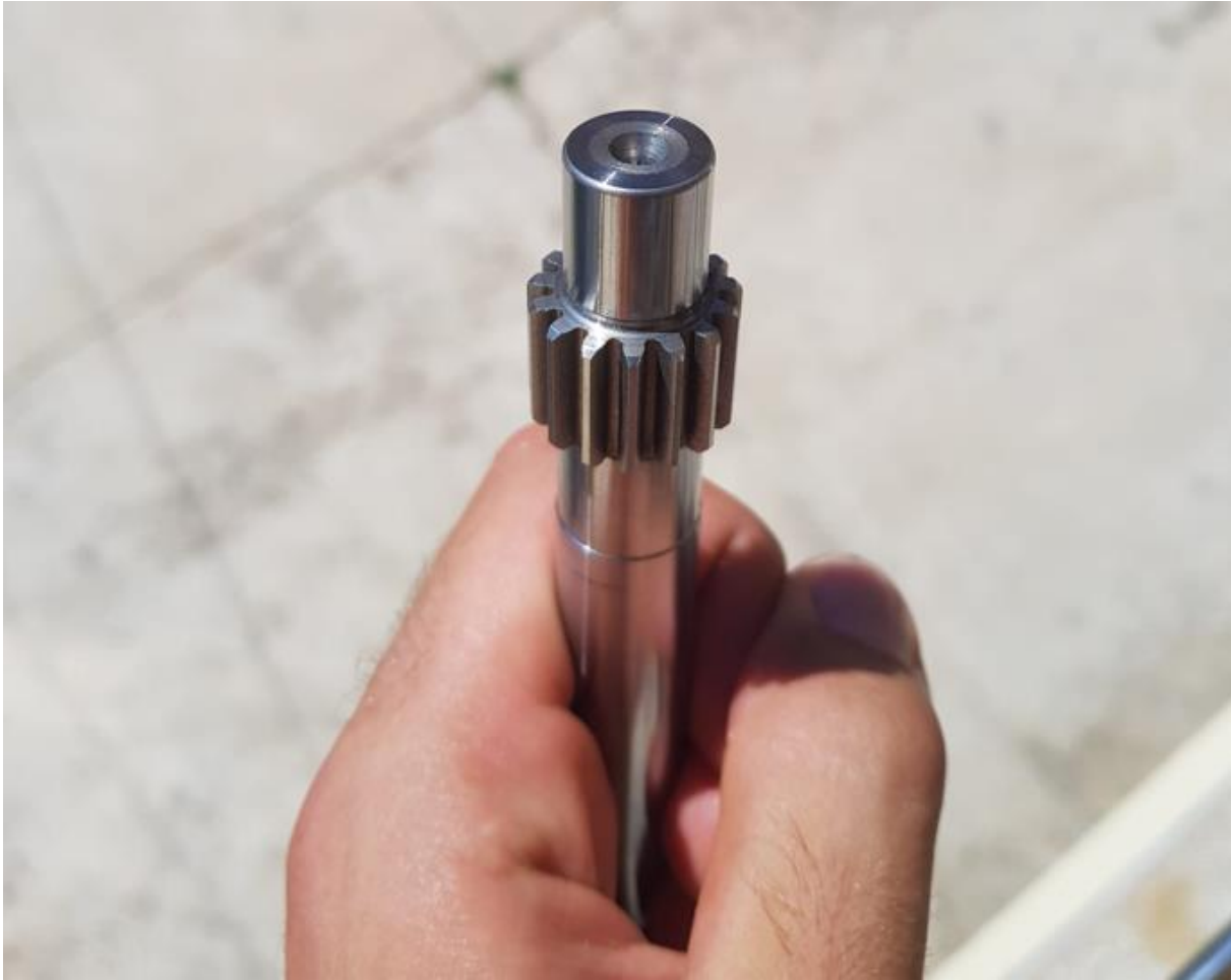
Slika 57 Ozubljenje na vratilu
