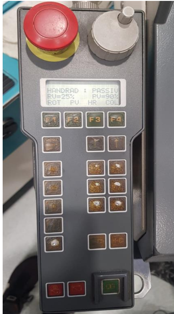
Slika 40 Uređaj za pomicanje alata
