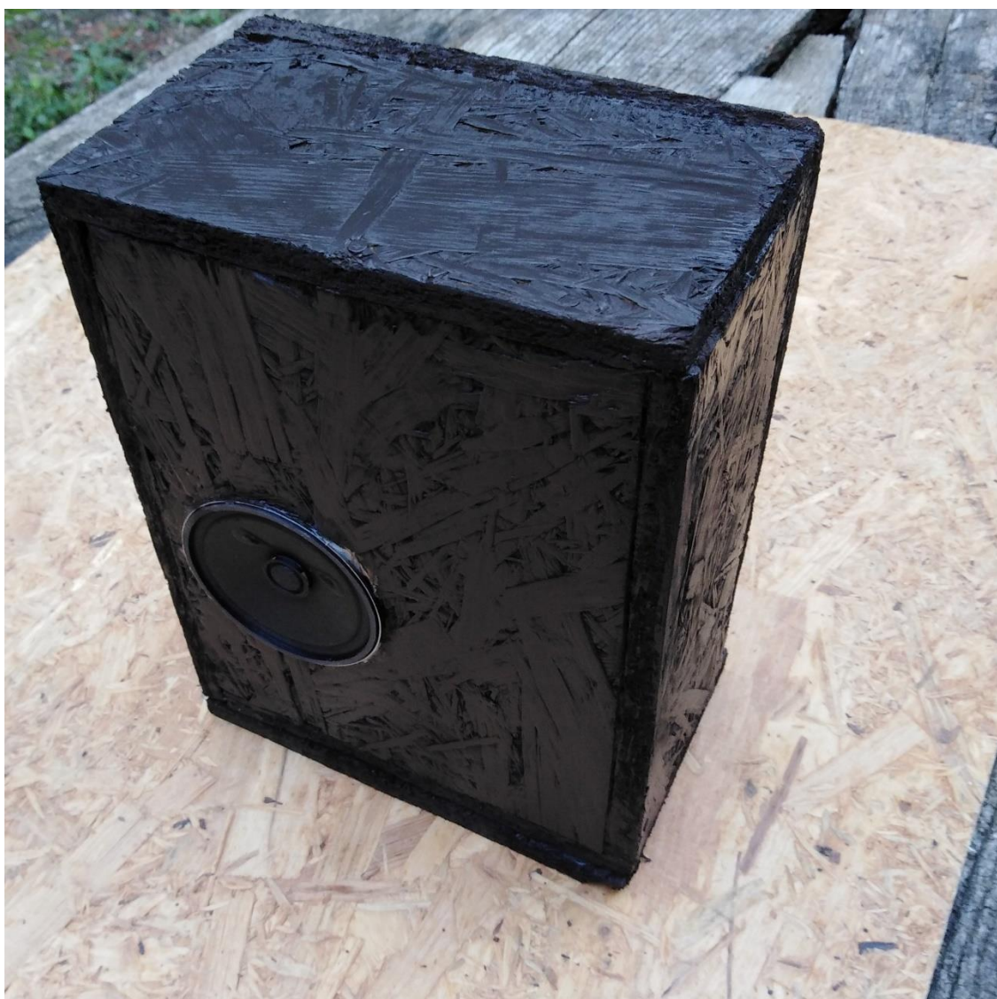
Slika 17. Gotova zvučnička kutija
