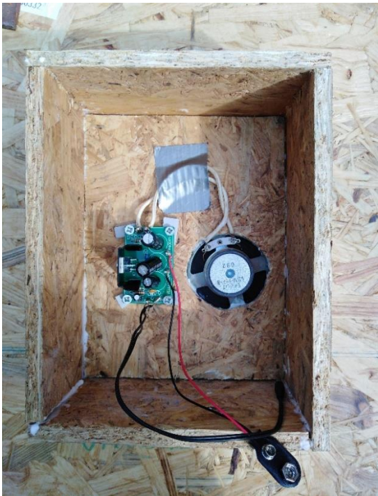
Slika 14. Zvučnička kutija prije postavljanja stražnje stranice
