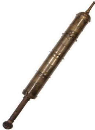
Slika 2. Ručna jedno stapna ručna pumpa za gašenje požara[4]
