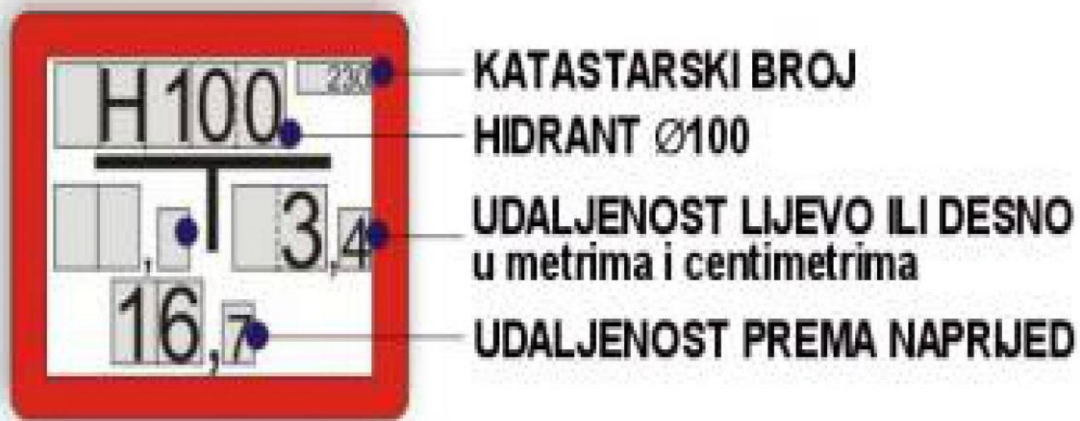
Slika 16. Pločica za oznaku podzemnog hidranta[19]
