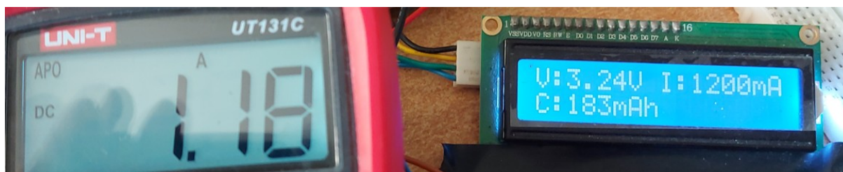
Slika 37. Prikaz izmjerene struje pražnjenja multimetrom u odnosu na prikazanu na LCD-u. Izvorno autor.
