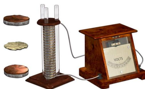
*Slika 3. Voltin elektrostatički stup. Izvor [5]*
