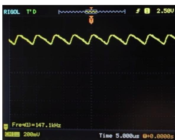
*Slika 33. Tranzistor se uključuje i isključuje frekvencijom od 150kHz. Izvorno autor.*
