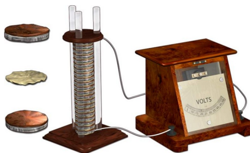
Slika 3. Voltin elektrostatički stup. Izvor [5]
