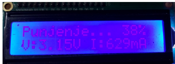
Slika 43. Prikaz SoC-a, napona baterije i struje punjenja. Izvorno autor.
