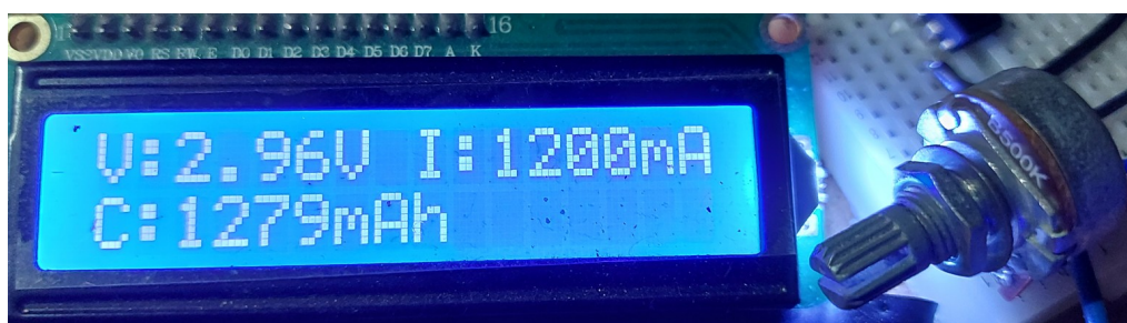
Slika 39. Prikaz pražnjenja Samsung INR18650-15L ćelije. Izvorno autor.
