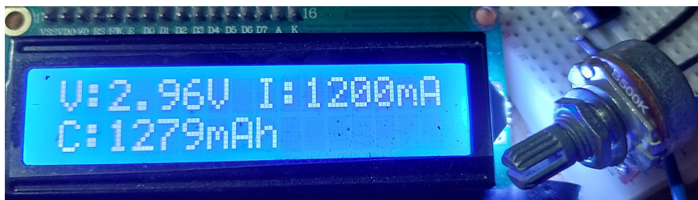
Slika 39. Prikaz pražnjenja Samsung INR18650-15L ćelije. Izvorno autor.
