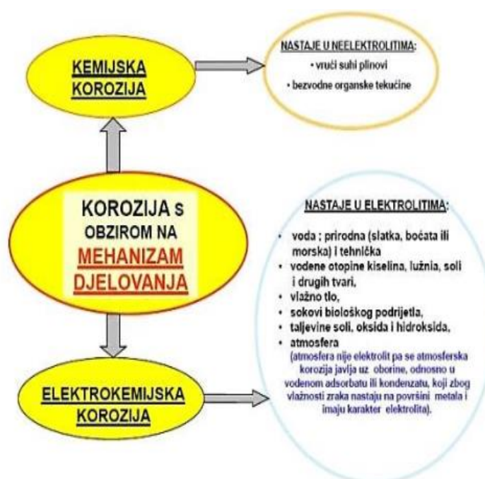
Slika 7. Podjela korozije prema mehanizmu djelovanja [6]
