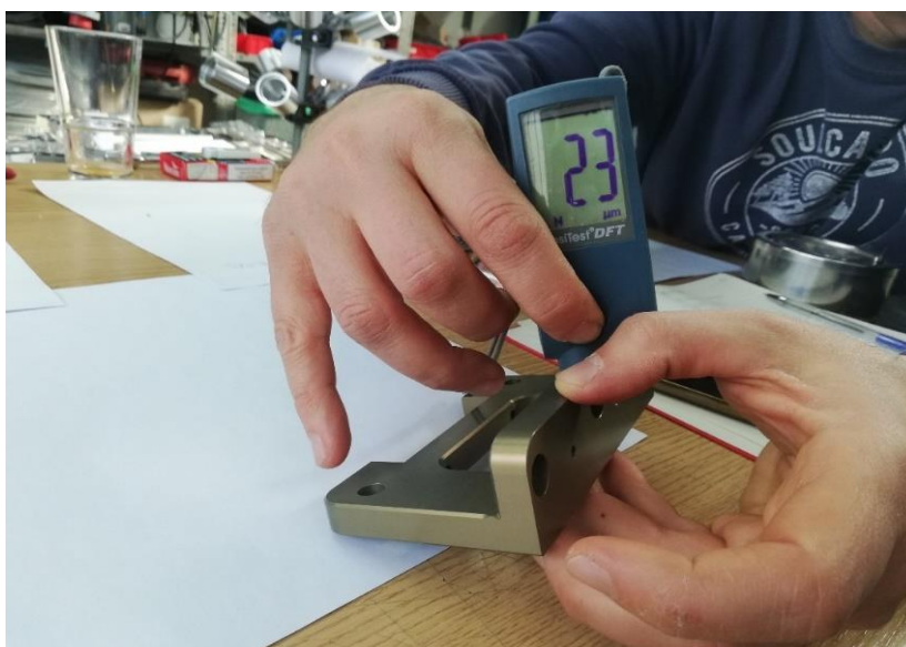
Slika 23. Provjera debljina nanosa – 1
