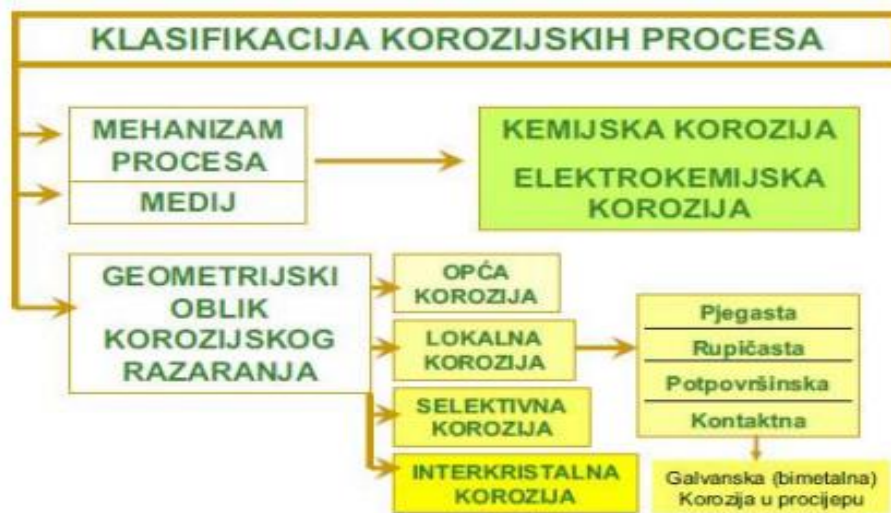
Slika 6. Klasifikacija korozijskih proces [7]
