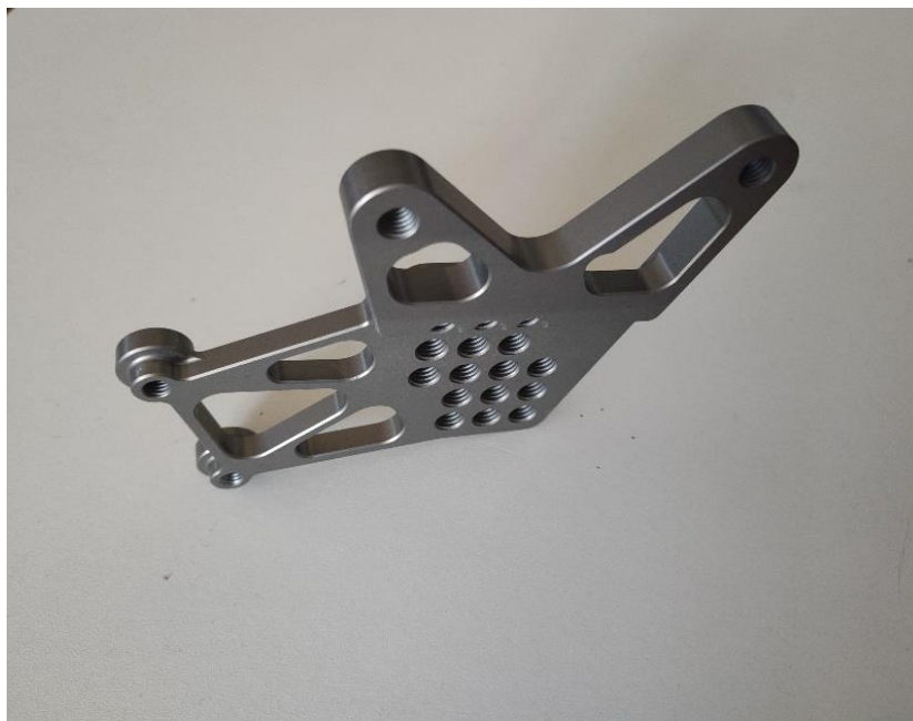
Slika 21. Pozicija EN AW 5083 poslije tvrdog eloksiranja
