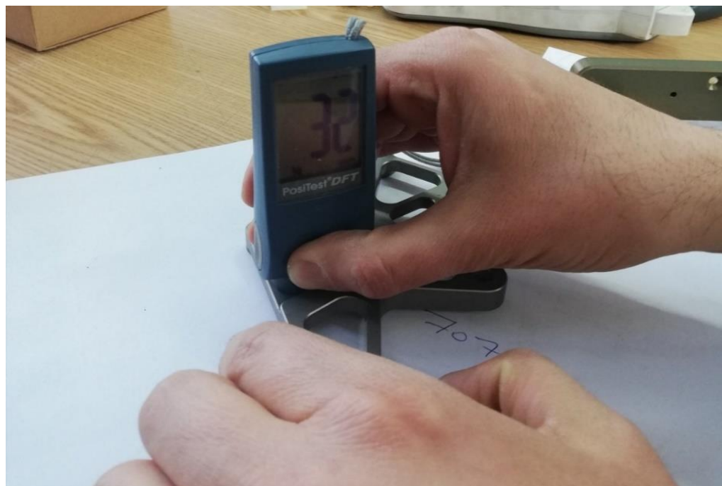
Slika 25. Provjera debljina nanosa – 3
