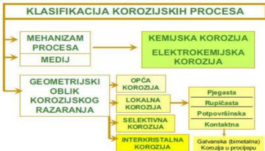
**Slika 6.** Klasifikacija korozijskih proces [7]
