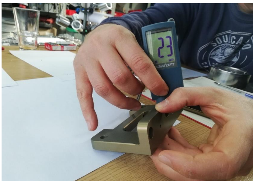
Slika 23. Provjera debljina nanosa – 1
