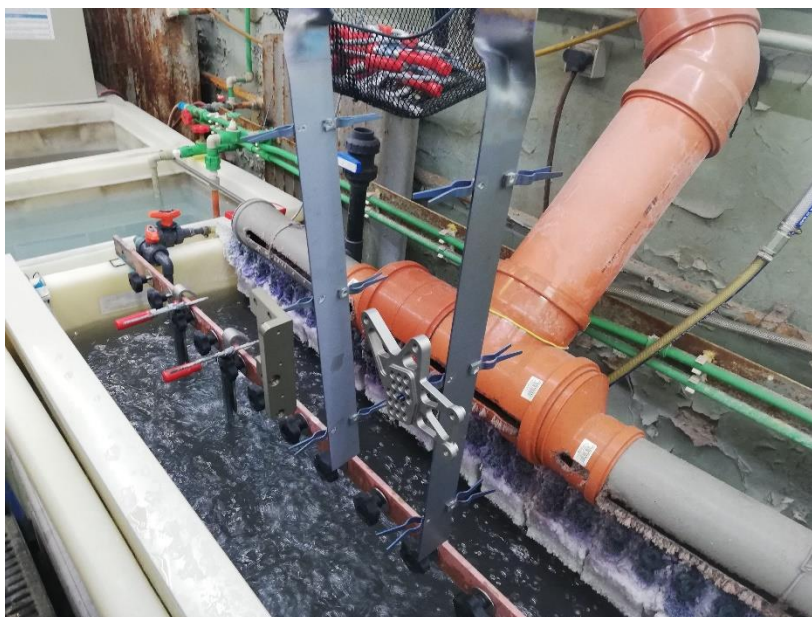
Slika 18. Kada za eloksiranje i postupak
