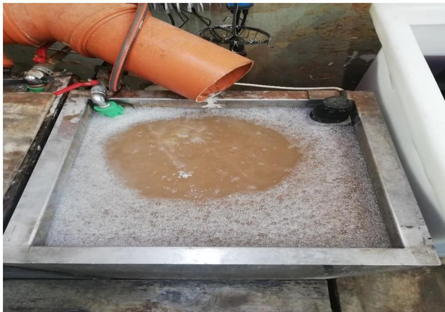
**Slika 15.** Kada za odmaščivanje obradaka u alkalnom deterdžentu
