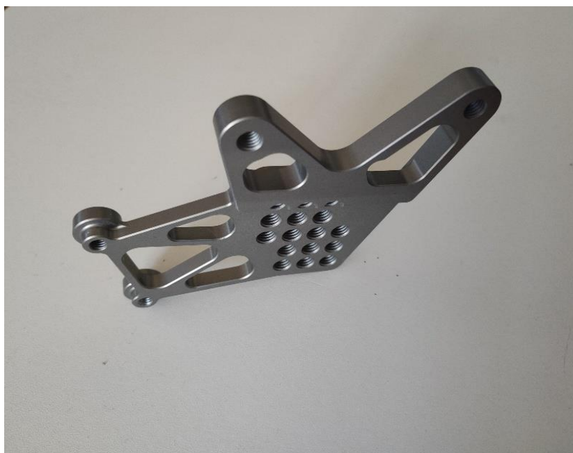
Slika 21. Pozicija EN AW 5083 poslije tvrdog eloksiranja
