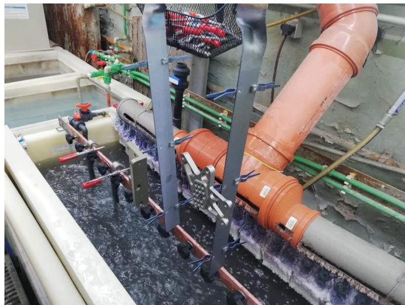
**Slika 18.** Kada za eloksiranje i postupak
