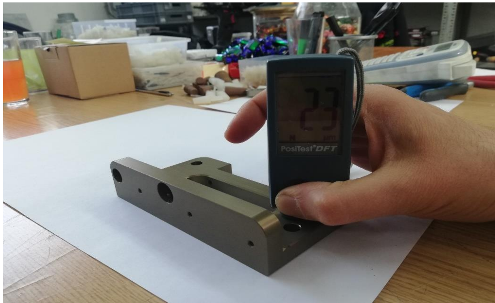
Slika 24. Provjera debljina nanosa – 2
