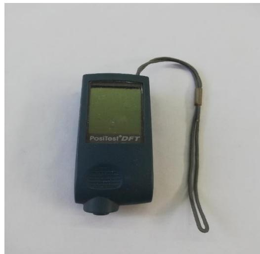
**Slika 22.** Mjerač debljine nanosa DFT Combo
