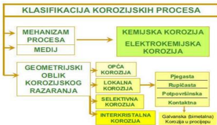
Slika 6. Klasifikacija korozijskih proces [7]
