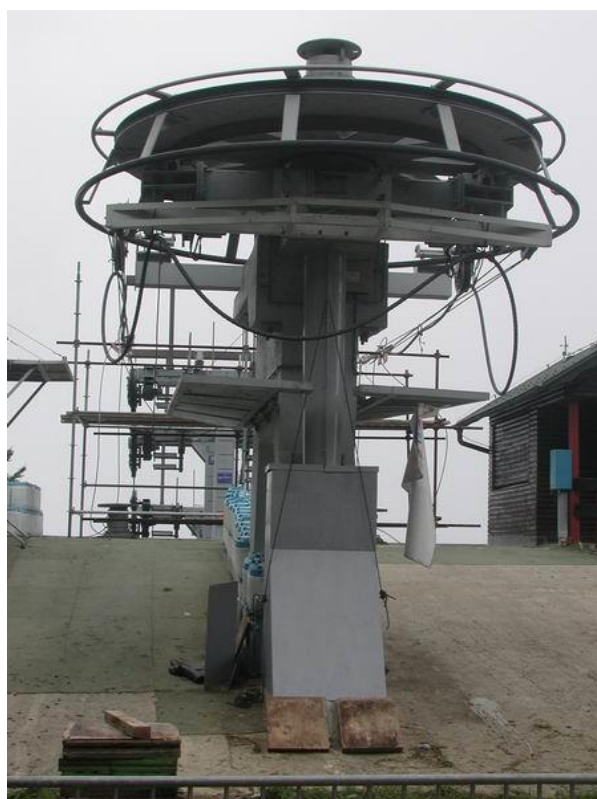
Slika 51. Montiran pogonski okretni kotač [7]
