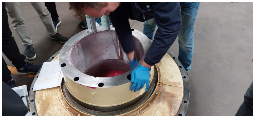
Slika 14. Uklanjanje viška penetranta [7]
