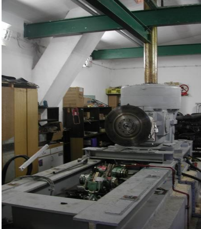
Slika 34. Demontirani motor, kardanski spoj i kočioni sustav [7]
