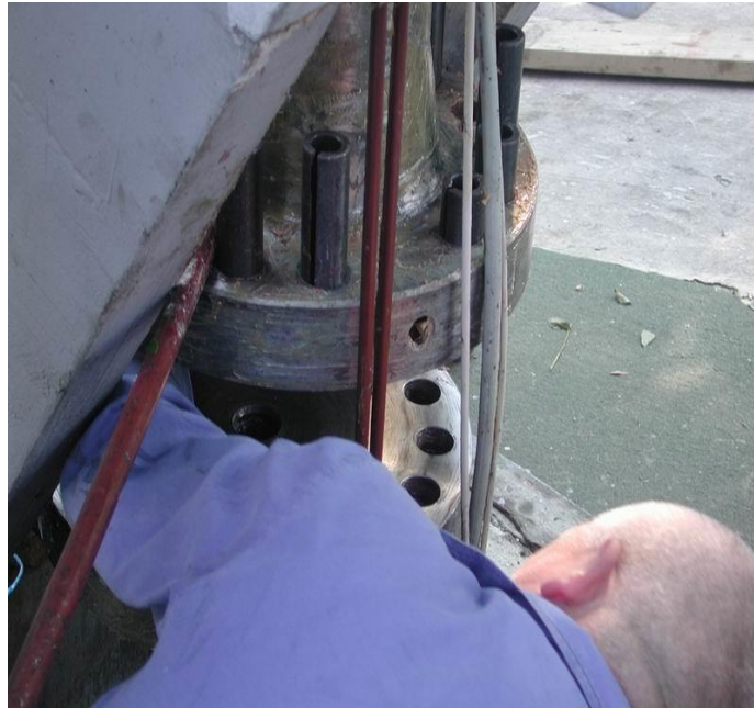
Slika 47. Vežanje vratila mekim gurnama i atestiranim užetom [7]
