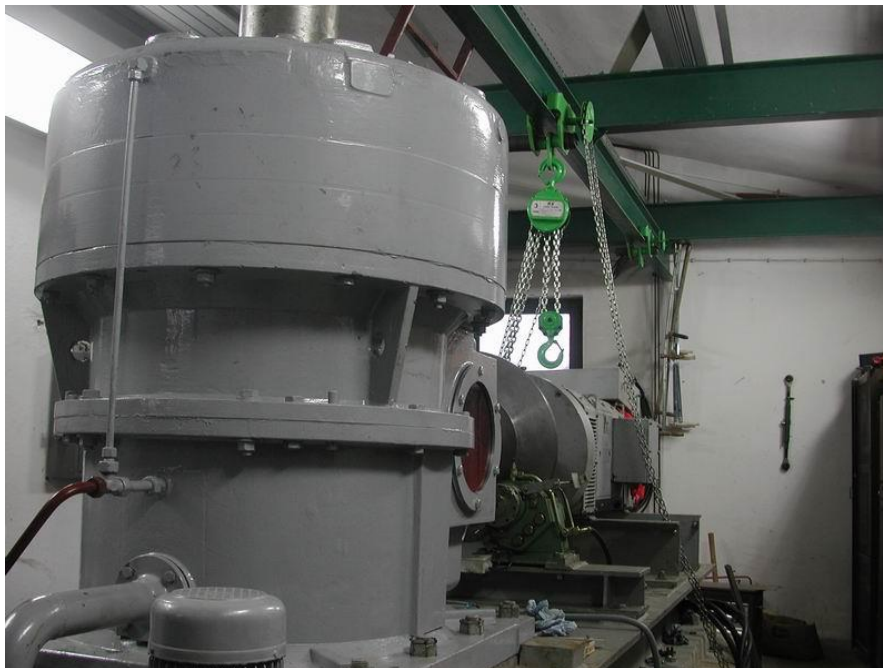
Slika 52. Montaža motora, kardanskog spoja i hidrauličkog kočionog sustava [7]
