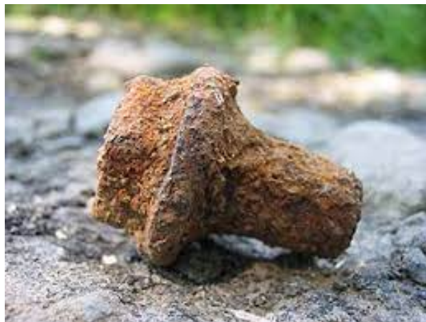
Slika 9. Elektrokemijska korozija ( https://hr.wikipedia.org/wiki/Korozija , Pristupljeno 20.12.2022.)
