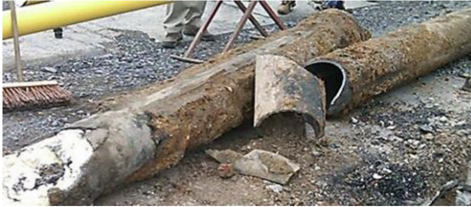
Slika 19. Grafitizacija sivog lijeva
