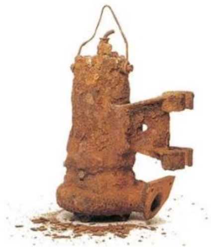
Slika 10. Opća korozija pumpe od lijevanog željeza [17]
