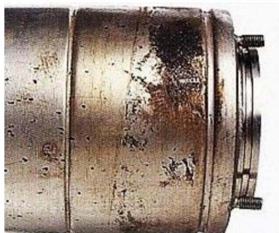
**Slika 14.** Rupičasta korozija dijela osovine nehrđajućeg čelika
