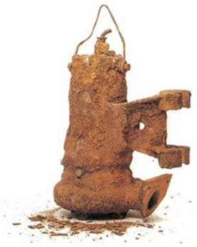
**Slika 10.** Opća korozija pumpe od lijevanog željeza [17]
