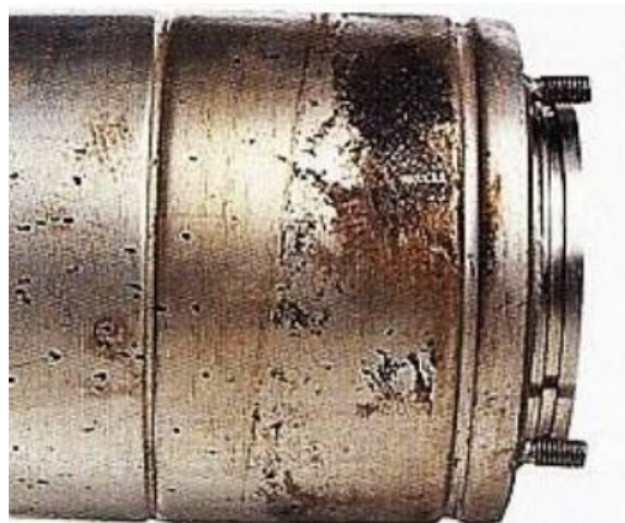
Slika 14. Rupičasta korozija dijela osovine nehrđajućeg čelika ( http://xapps.xyleminc.com/Crest.Grindex/help/grindex/contents/Metals.htm , Pristupljeno 20.12.2022.)
