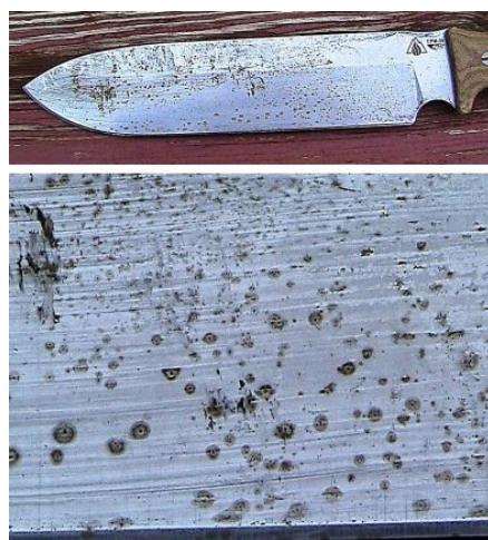
**Slika 13.** Pjegasta korozija na oštici noža
