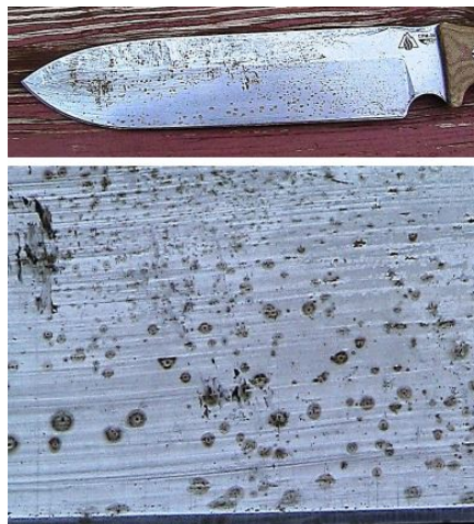
Slika 13. Pjegasta korozija na oštrici noža
