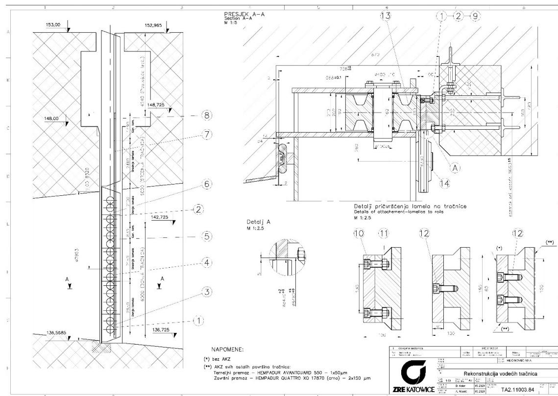
Slika 4.2 Sklopni nacrt vodećih tračnica
