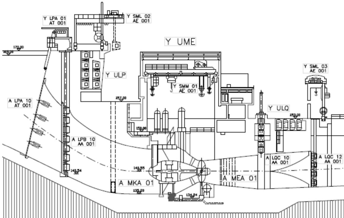
Slika 2.2 Hidroelektrana Čakovec, poprečni presjek Kaplan turbine
