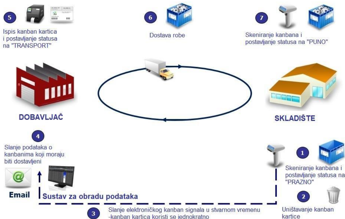
Slika 4 Shema Kanban sustava [4]
