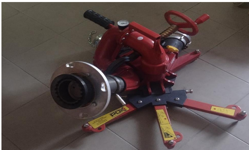
Sl. 15. Prijenosni bacač za gašenje vodom i pjenom [Vlastita fotografija]
