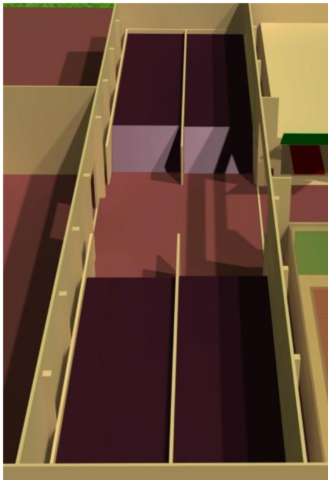
Slika 54. Pregrade za prozračivanje komposta - dozrijevanje.
