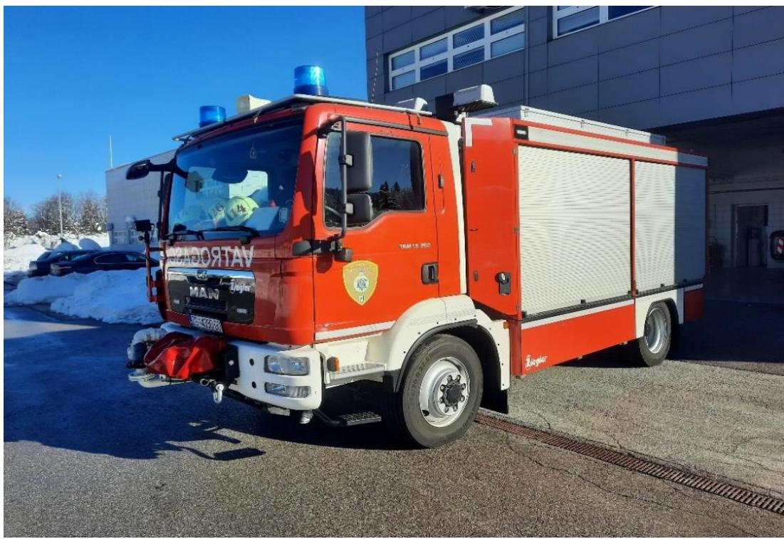
Slika 3. Veliko kombinirano tunelsko vozilo (vlastiti izvor)
