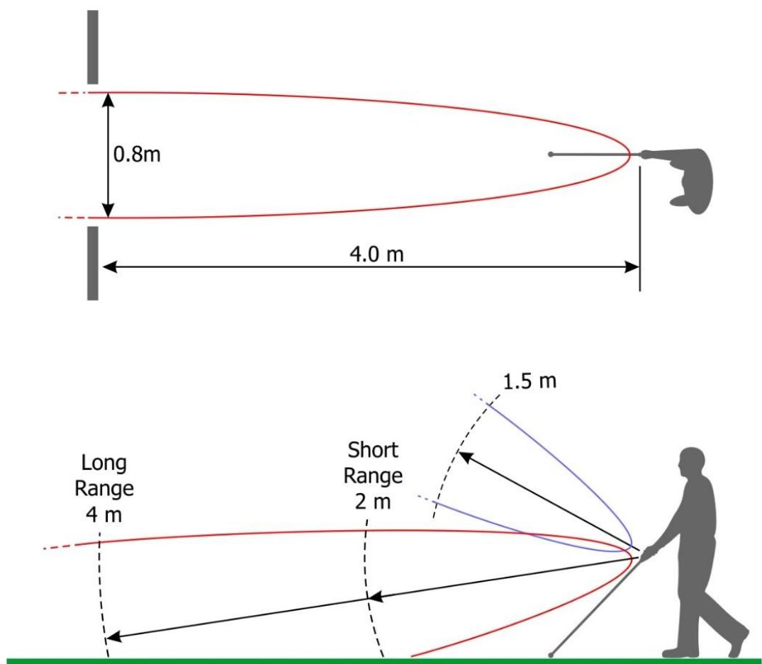
Slika 2. Način na koji Ultra Cane elektronski bijeli štap, pomoću ultrazvučnih valova i senzora, skenira prostor između korisnika, to jest, slijepе ili slabovidne osobe, dajući informacije korisniku o preprekama tijekom kretanja [13]
