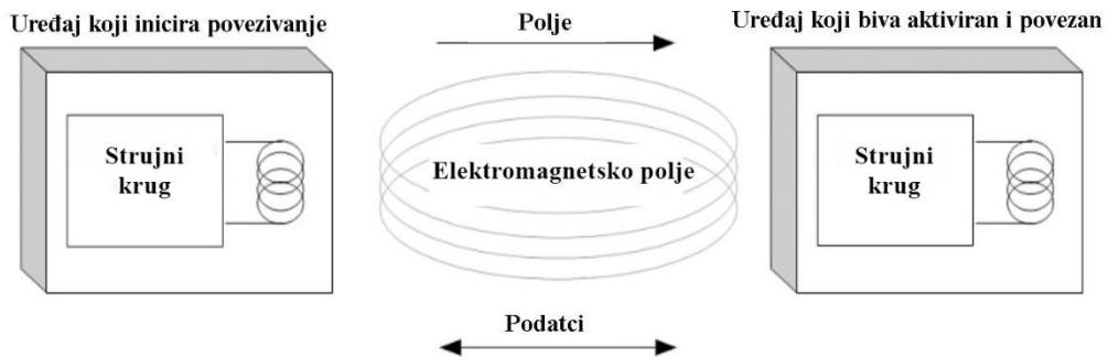
Slika 7. Bazični grafički prikaz funkcioniranja NFC sustava [24]
