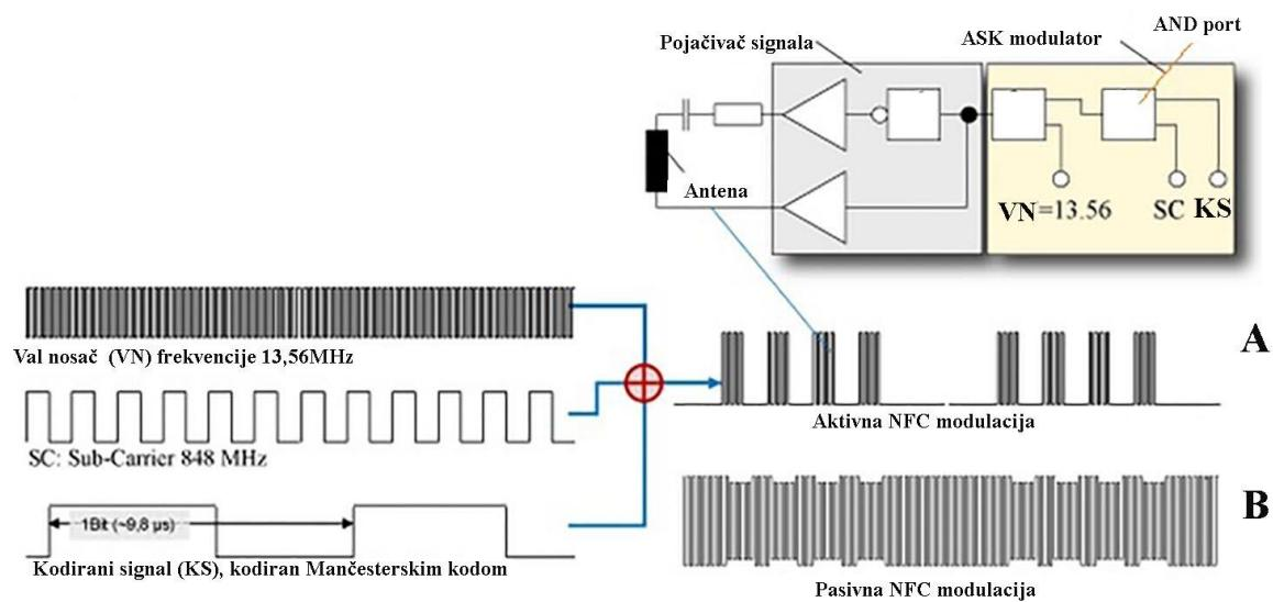
Slika 10. Aktivno i pasivno moduliranje kod NFC tehnologije [30]
