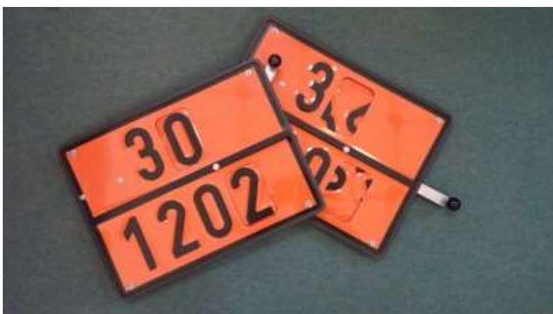
Slika 22. Narančasta ploča za označavanje vozila koje prijevozi plinsko ulje ili dizelsko gorivo ili lož ulje prema ADR-u. [52]
