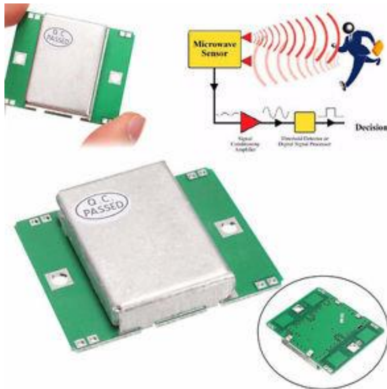
Slika 5. Predodžba mikrovalnog detektora [11]
