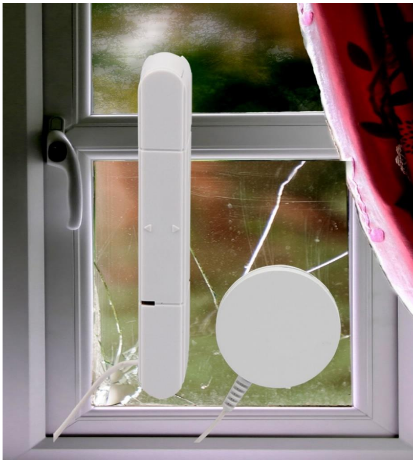
Slika 2. Predodžba kontaktnog detektora loma stakla [7]
