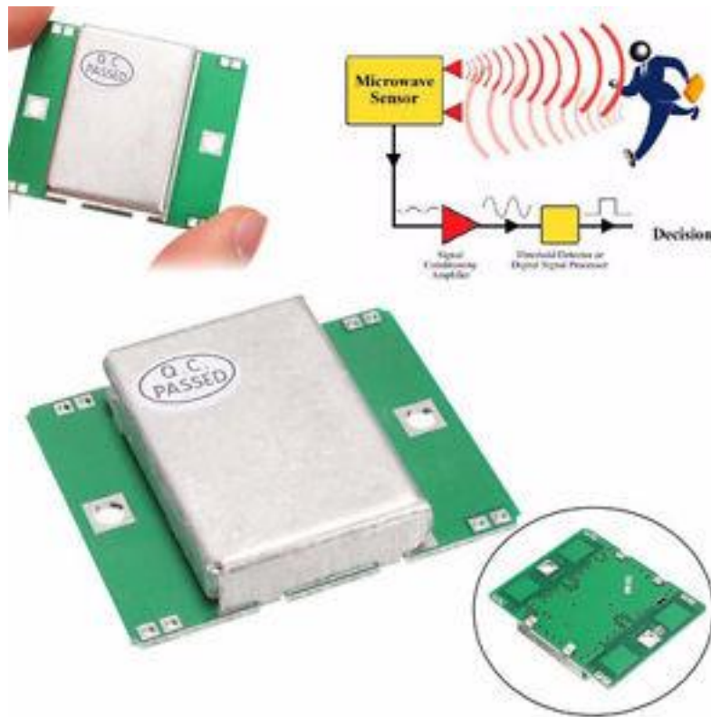
Slika 5. Predodžba mikrovalnog detektora [11]
