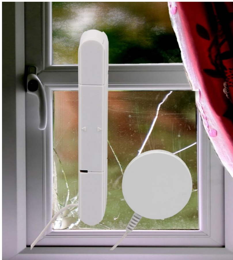
Slika 2. Predodžba kontaktnog detektora loma stakla [7]
