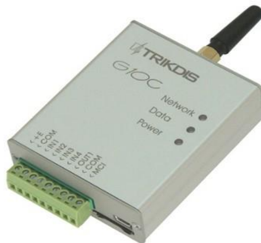
Slika 10. Predodžba GSM digitalnog komunikatora [17]
