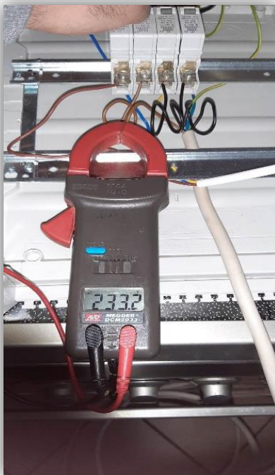
Slika 18. Napon kada je toster uključen
