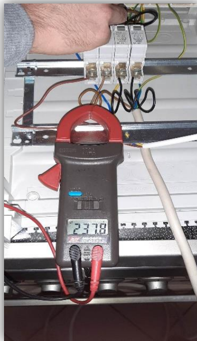
Slika 17. Napon kada je toster isključen
