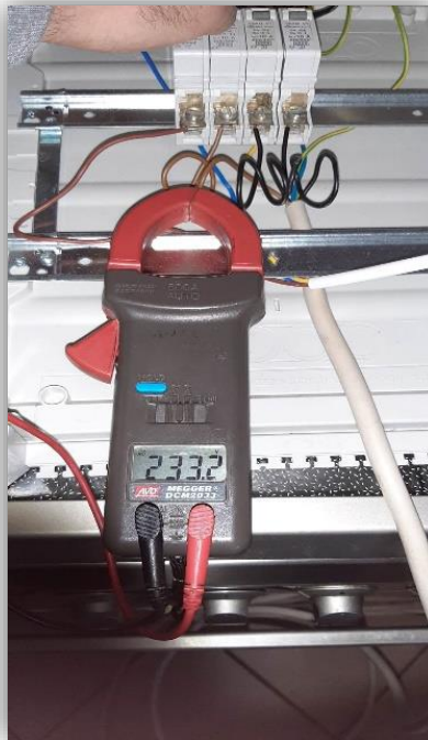
Slika 18. Napon kada je toster uključen
