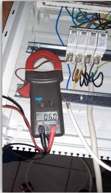
Slika 16. Jakost struje kada je friteza uključena
