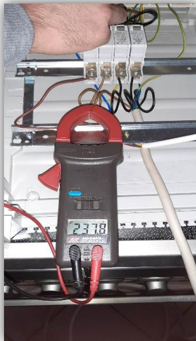
Slika 17. Napon kada je toster isključen
