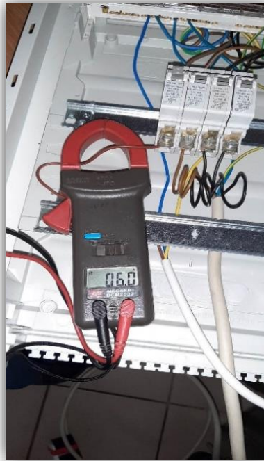
Slika 16. Jakost struje kada je friteza uključena
