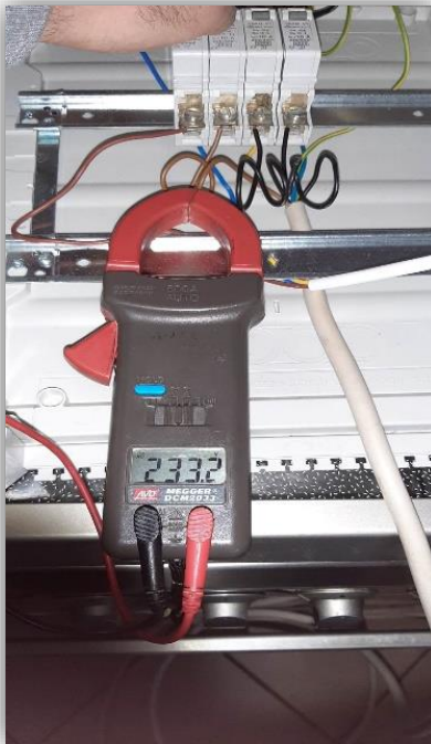
Slika 18. Napon kada je toster uključen
