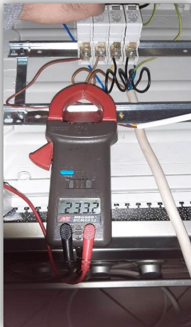
Slika 18. Napon kada je toster uključen
