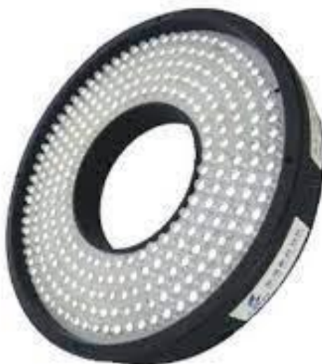
Slika 16. Primjer svjetla koje ostvaruje svijetlo polje [23]
