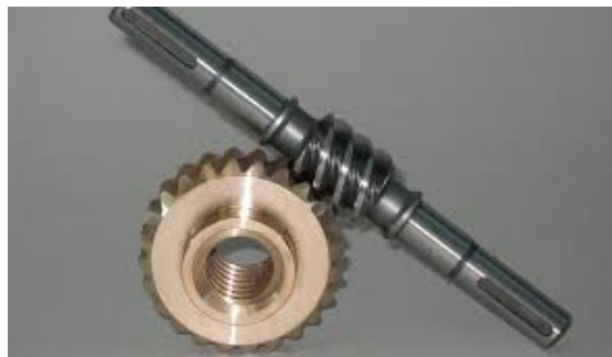
Slika 9. Vratilo kod pužnog prijenosnika [16]
