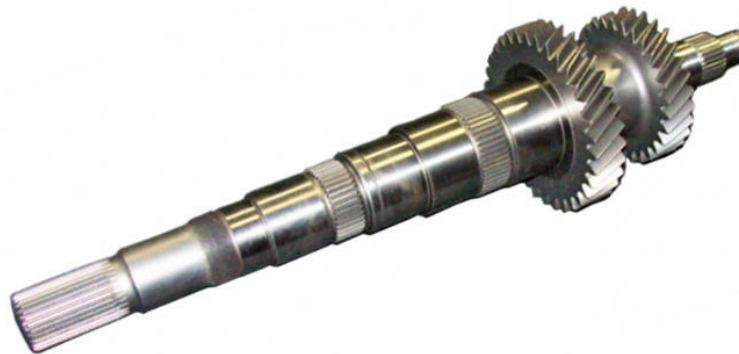
Slika 3. Ulazno (dovodno) vratilo [11]
