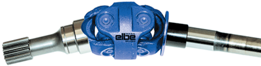
Slika 16. Dvostruko kardansko vratilo [23]
