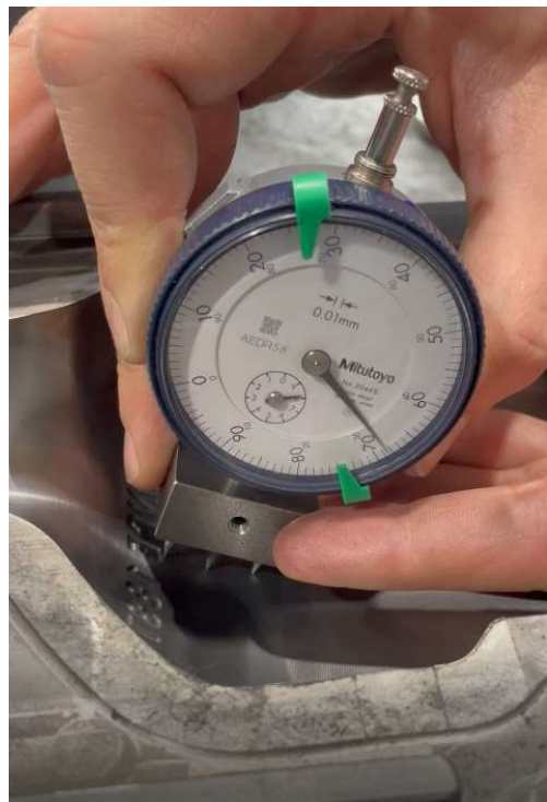
Slika 80. Dubina obrade u drugom zakretu
