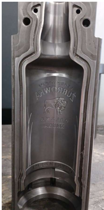
Slika 51. fazona nakon kopiranja na HSC 55 linear
