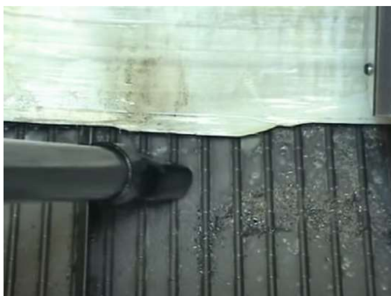
Slika 41. čišćenje kanala za odvod emulzije
