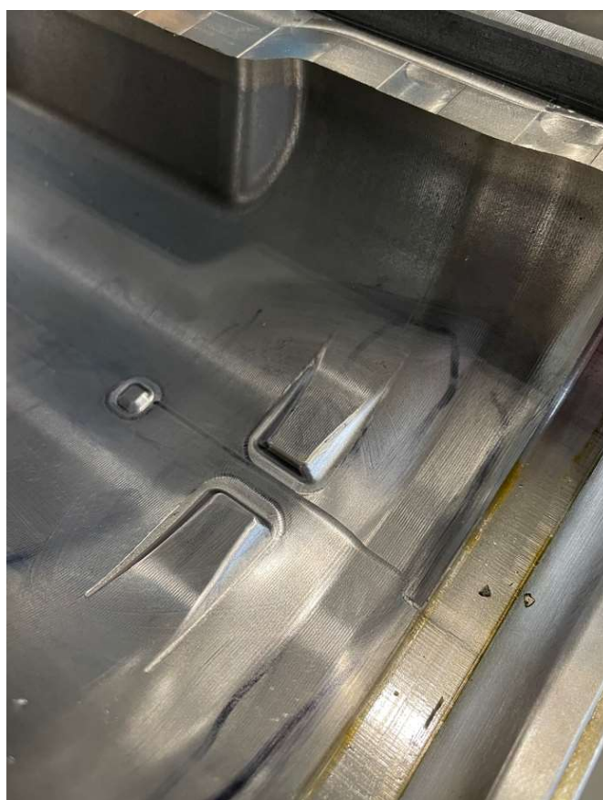
Slika 54. prijelazi dubine u donjem djelu fazone – obrađene površine
