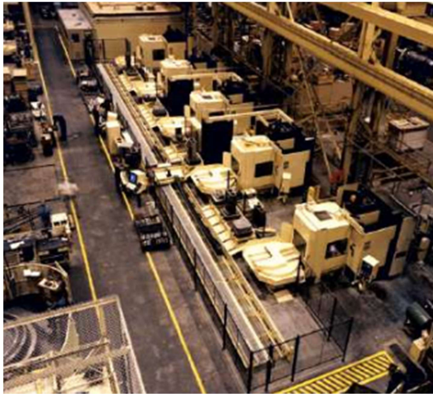
Slika 15. Prikaz fleksibilnog obradnog sustava [13]
