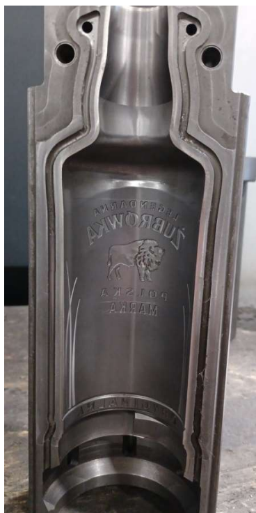
Slika 51. fazona nakon kopiranja na HSC 55 linear
