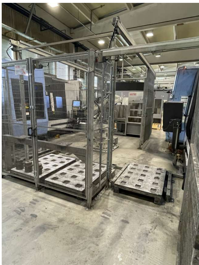
Slika 24. Fleksibilna obradna ćelija sa mjernom stanicom u tvrtki OMCO Croatia
