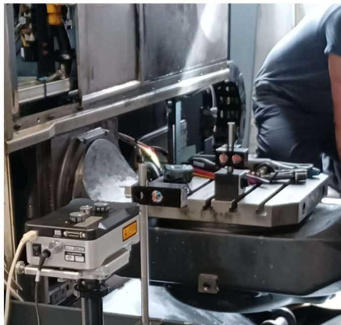
Slika 73. Stacionarni dio lasera i pomični montiran na stol
