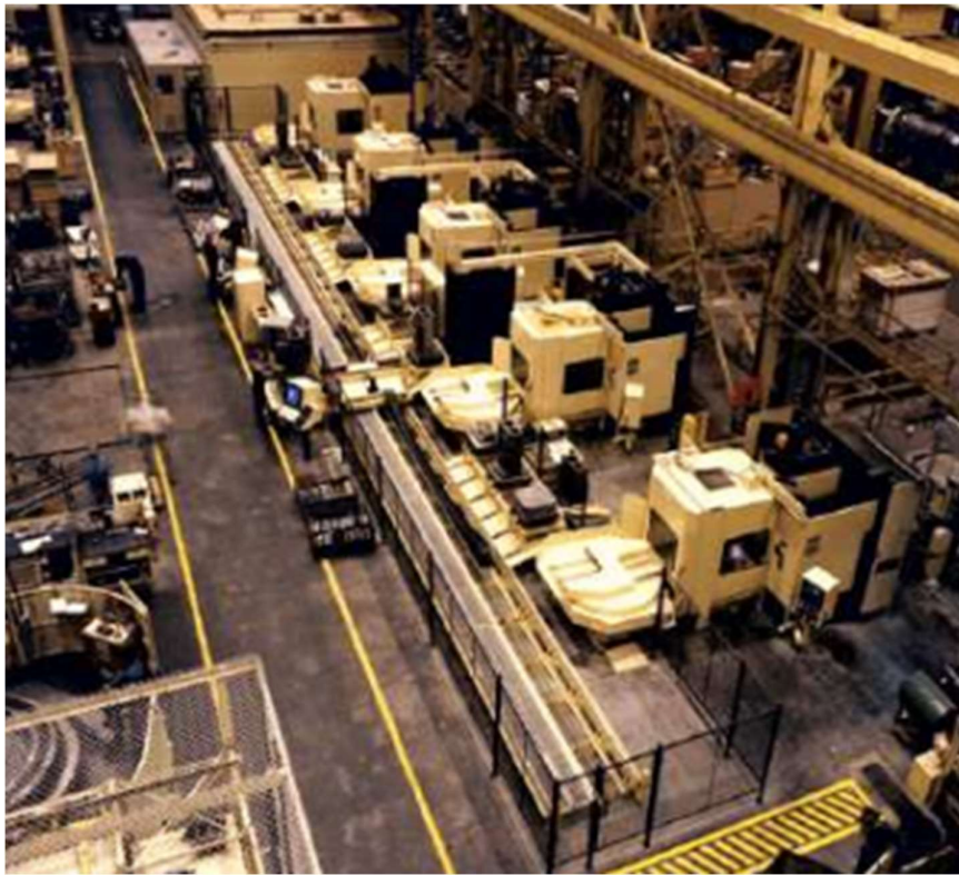
Slika 15. Prikaz fleksibilnog obradnog sustava [13]
