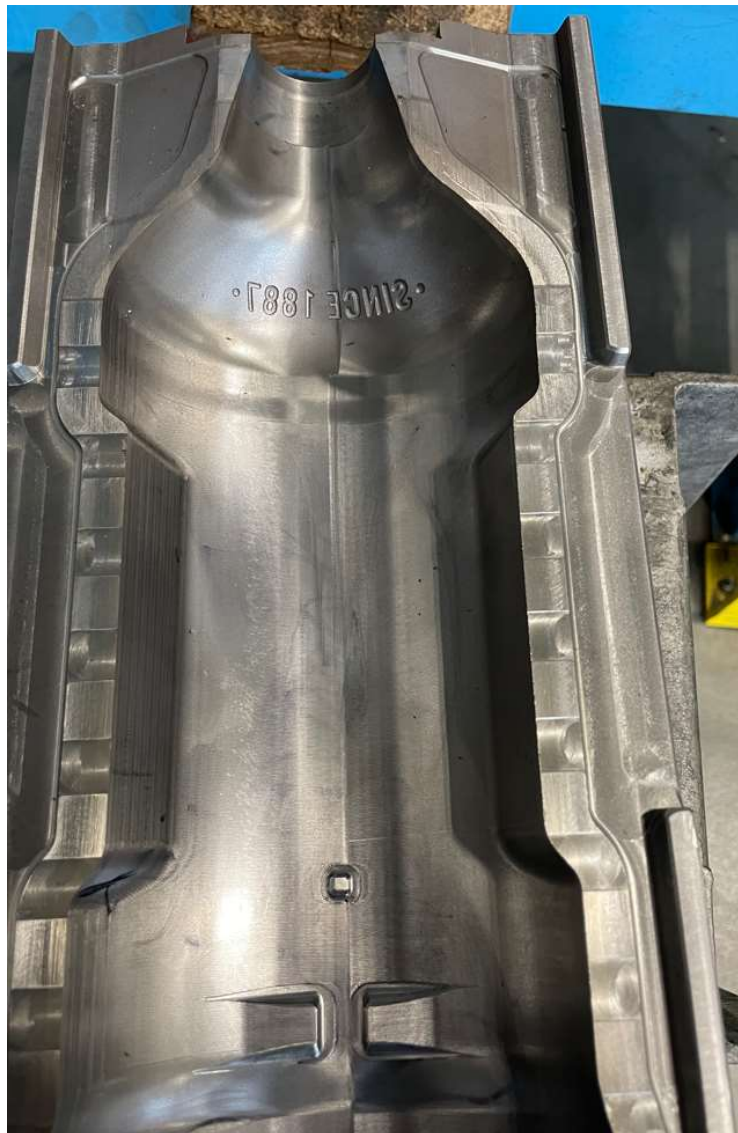
Slika 52. obradak sa vidljivim razlikama dubine u zakretima
