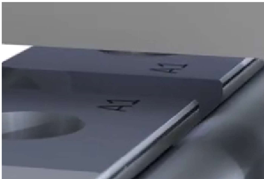
Slika 70. Pravilno spojene vodilice – oznaka A1 prema oznaci A1 [11]
