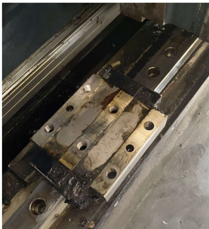
Slika 65. Odvojen pomični dio vodilice od radnog stroja
