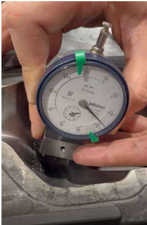
Slika 79. Dubina obrade u jednom zakretu
