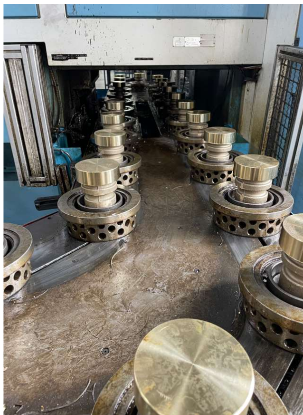
Slika 21. Sustav za automatiziranu izmjenu obradaka u tvrtki OMCO Croatia
