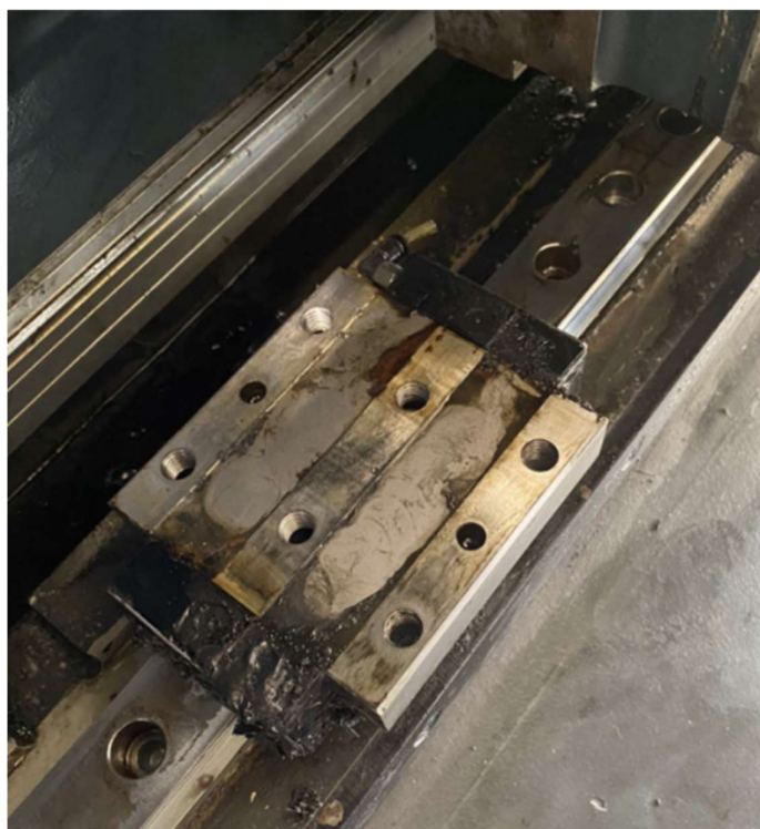
Slika 65. Odvojen pomični dio vodilice od radnog stroja
