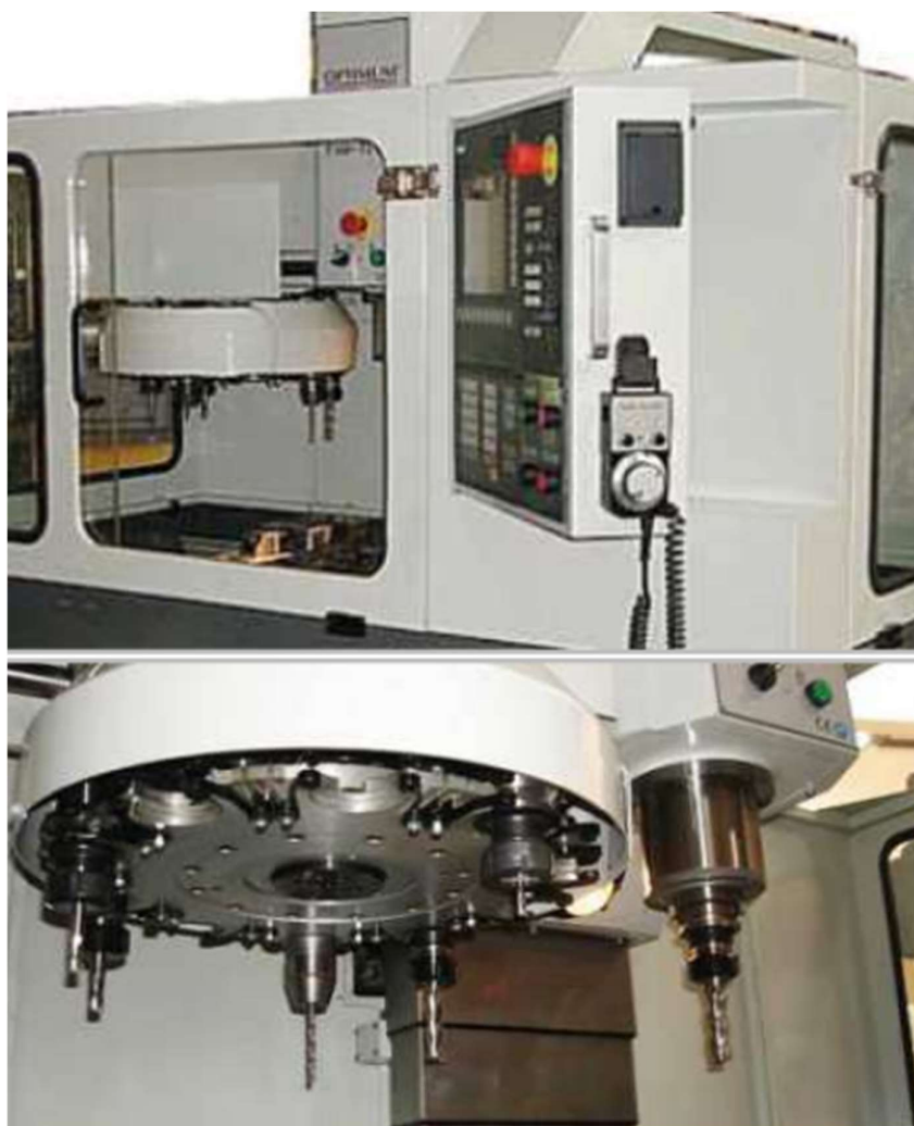
Slika 16. Automatizirani sustav izmjene alata sa magazinom za 10 alata [6]
