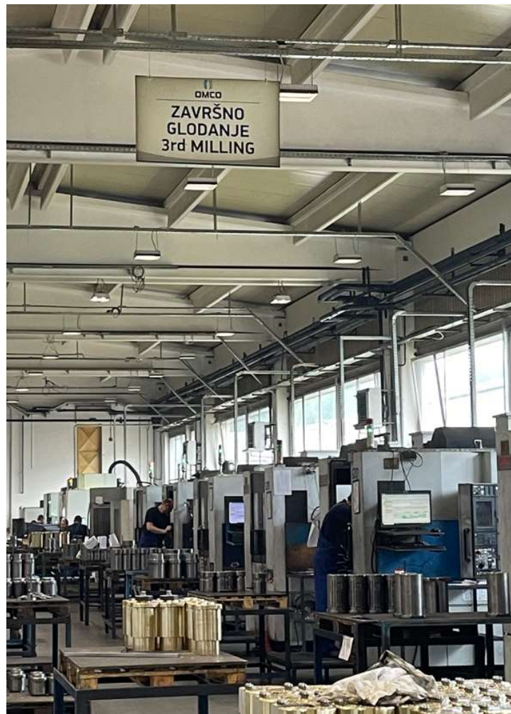
Slika 46. primjer označavanja faze obrade-završno glodanje
