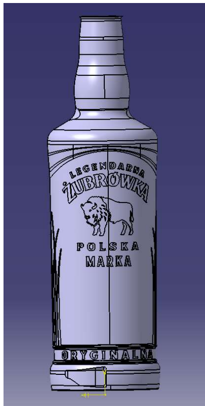
Slika 50. 3D model koji služi za kopiranje fazone
