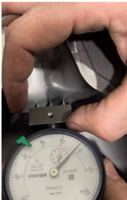
Slika 57. dubina glodanja u jednom zakretu
