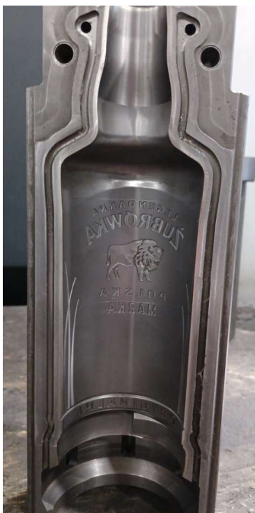
Slika 51. fazona nakon kopiranja na HSC 55 linear
