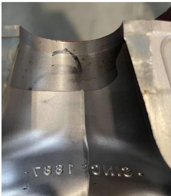
Slika 53. prijelazi u gornjem djelu fazone – obrađene površine
