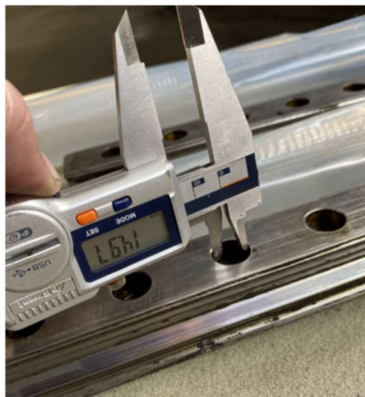
Slika 67. Mjerenje provrta za čepove
