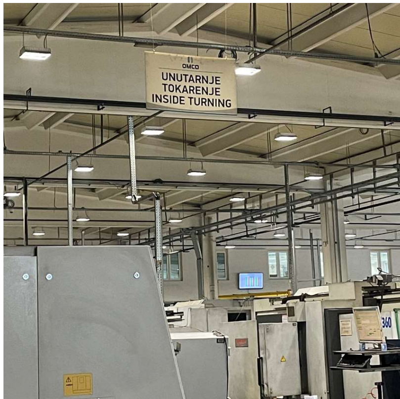
Slika 48. primjer označavanja faze obrade-unutarnje tokarenje
