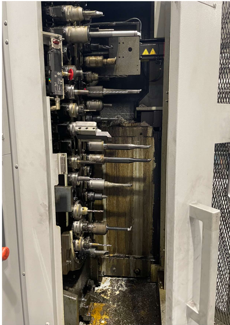
Slika 12. Prikaz spremišta (magazina) alata za automatski izmjenu alata
