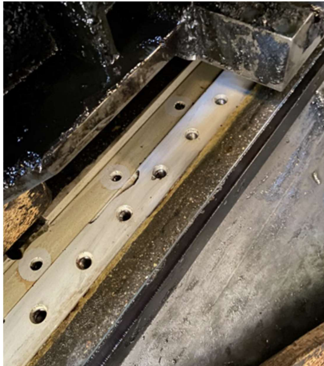
Slika 66. Odvojen nepomični dio vodilice od kućišta stroja
