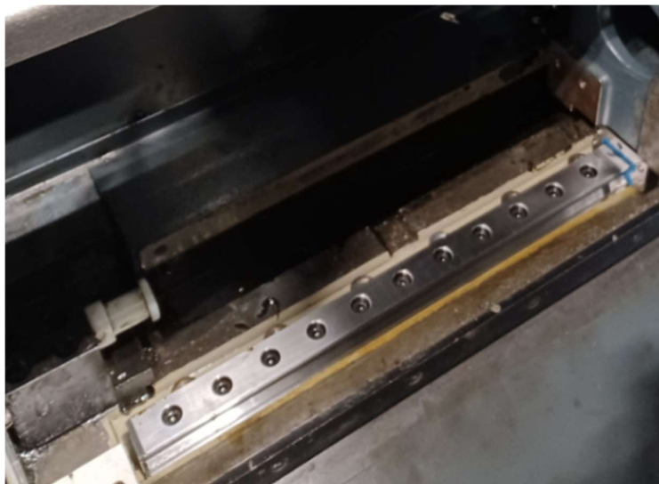
Slika 71. Prikaz montiranih novih vodilica
