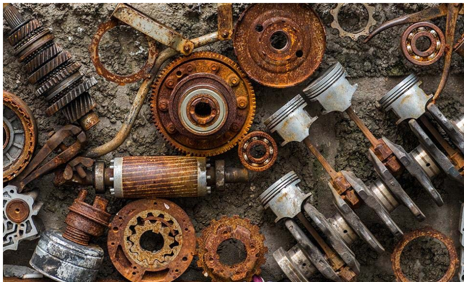
Slika 12. Primjer korozije raznih tehničkih materijala u izradcima [23]
