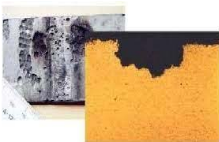
Slika 13. Detalj primjer pjegaste korozije [17]
