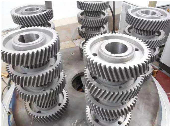
Slika 9. Nitrirani čelični zupčanici[21]
