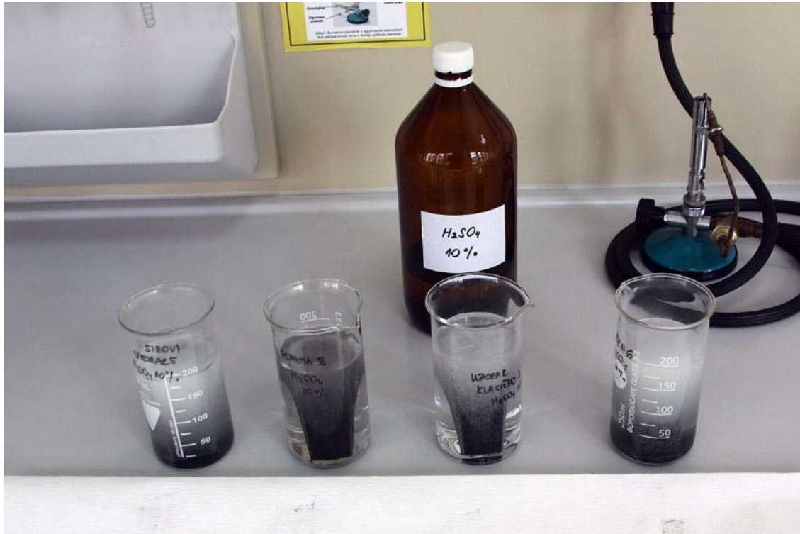
Slika 15. Rekcija sumporne kiseline s čelicima eksperiment: lijevi uzorak nenitrirani
