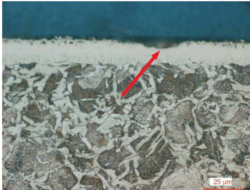
Slika 10. Deformacija nitridnog sloja vidi se na mjestu gdje se gubi fokus fotografije [22]
