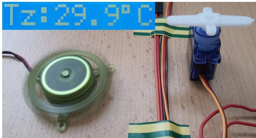
Slika 37. Predodžba testiranja sustava prozračivanja (uključeno)
