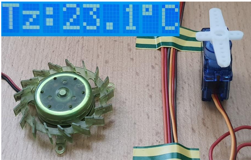
Slika 36. Predodžba testiranja sustava prozračivanja (isključeno)
