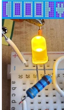
Slika 38. Predodžba testiranja sustava detekcije količine vode (uključeno)
