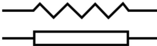
Slika 19. Predodžba dva uobičajena shematska simbola otpornika [35]
