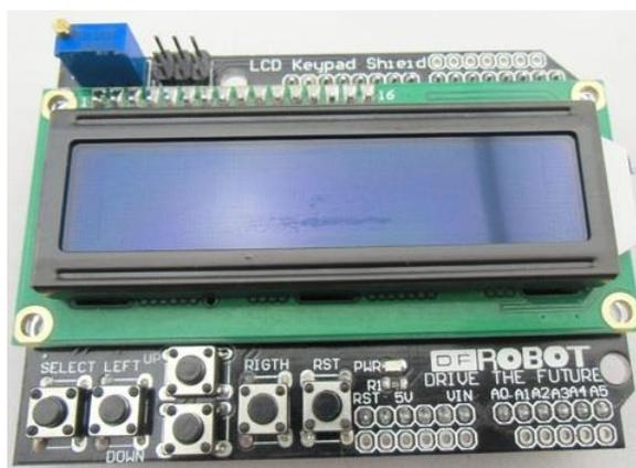
Slika 5. Predložba LCD keypad shield-a [13]
