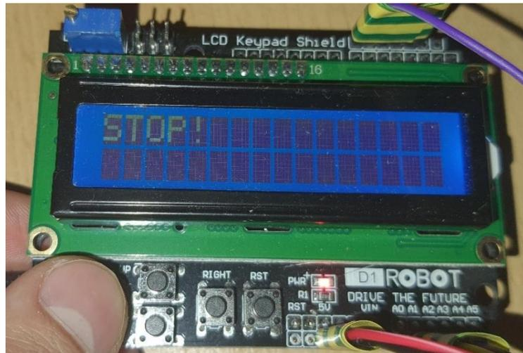
Slika 54. Predodžba manualnog isključivanja svih izvršnih funkcija
