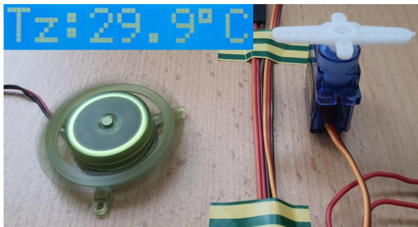
Slika 37. Predodžba testiranja sustava prozračivanja (uključeno)
