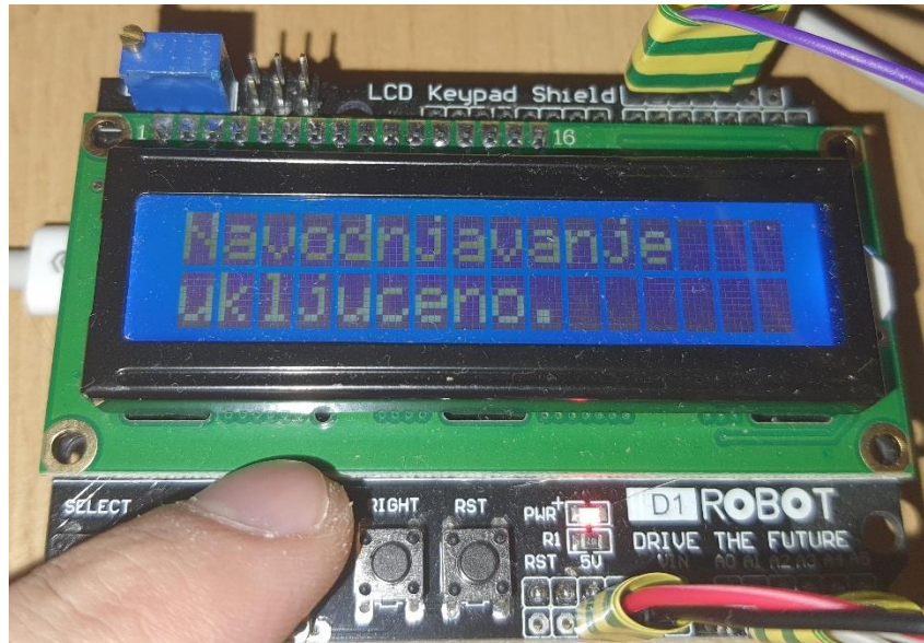
Slika 48. Predodžba manualnog pokretanja funkcije navodnjavanja
