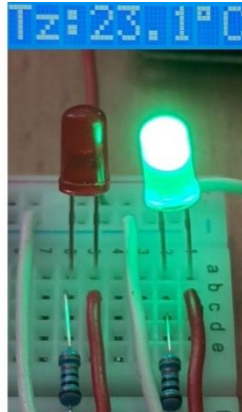
Slika 34. Predodžba testiranja sustava grijanja (uključeno)
