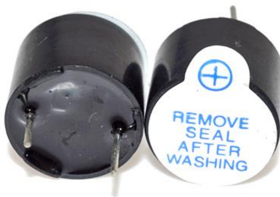
Slika 15. Predodžba aktivne zujalice [28]
