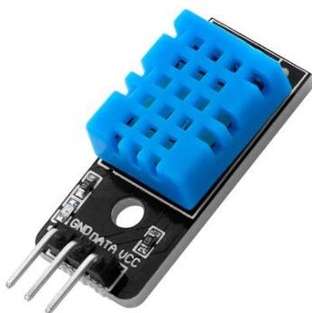
Slika 6. Predodžba senzora temperature i vlage zraka [15]
