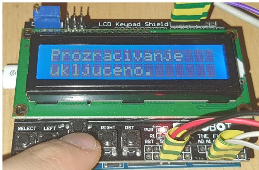
Slika 51. Predodžba manualnog pokretanja funkcije prozračivanja
