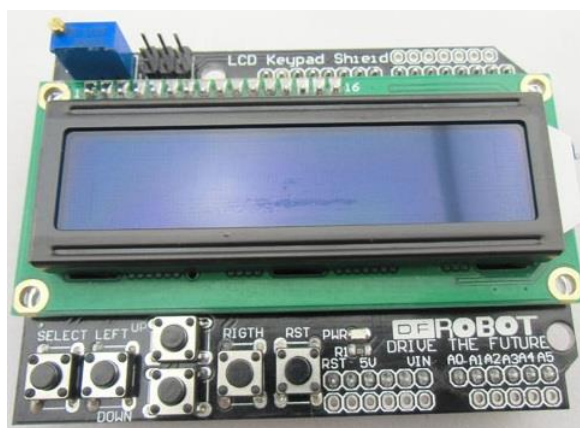
Slika 5. Predložba LCD keypad shield-a [13]
