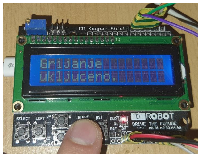
Slika 45. Predodžba manualnog pokretanja funkcije grijanja
