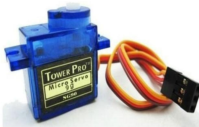
Slika 14. Predodžba servo motora [26]
