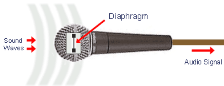
Slika 4. Predodžba pozicije membrane u mikrofonu [7].
