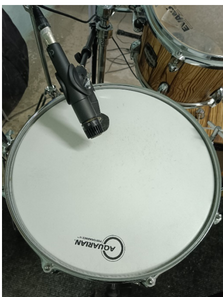
Slika 21. Pozicija mikrofona za snimanje doboša
