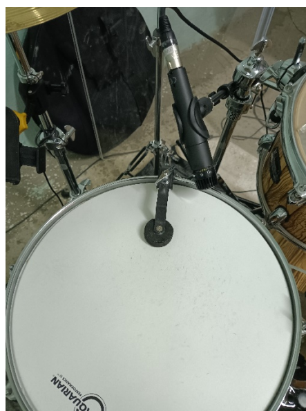
Slika 21. Pozicija mikrofona za snimanje doboša
