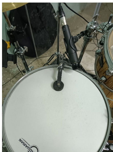
Slika 21. Pozicija mikrofona za snimanje doboša
