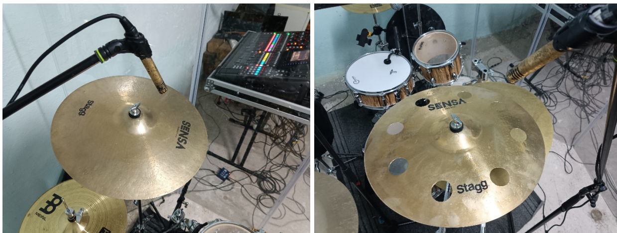
Slika 33. Pozicija mikrofona za snimanje Brilliant Crash (slika lijevo) i Orbis Crash činele (slika desno)
