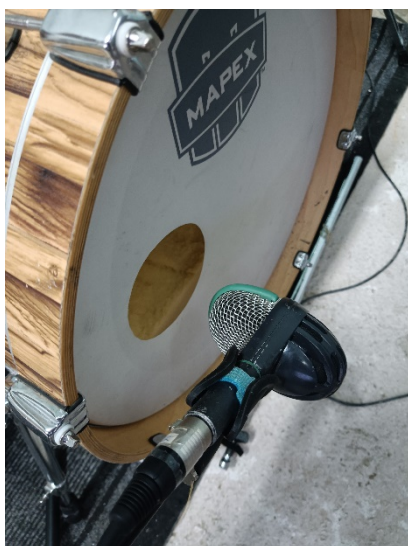
Slika 18. Pozicija mikrofona za snimanje bas bubnja
