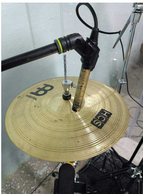
Slika 30. Pozicija mikrofona za snimanje hi-hat činele
