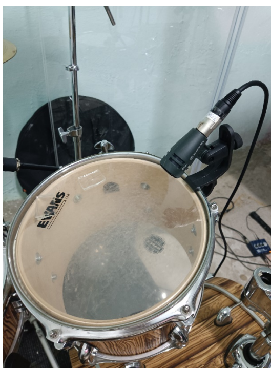
Slika 24. Pozicija mikrofona za snimanje high tom bubnja
