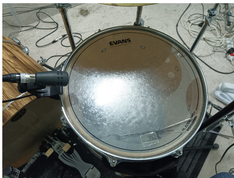
Slika 27. Pozicija mikrofona za snimanje floor tom bubnja
