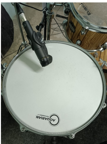
Slika 21. Pozicija mikrofona za snimanje doboša
