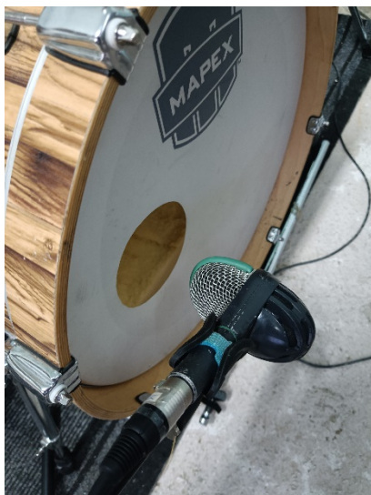
Slika 18. Pozicija mikrofona za snimanje bas bubnja
