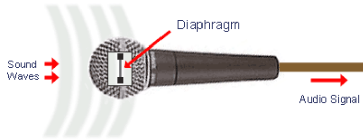
Slika 4. Predodžba pozicije membrane u mikrofonu [7].
