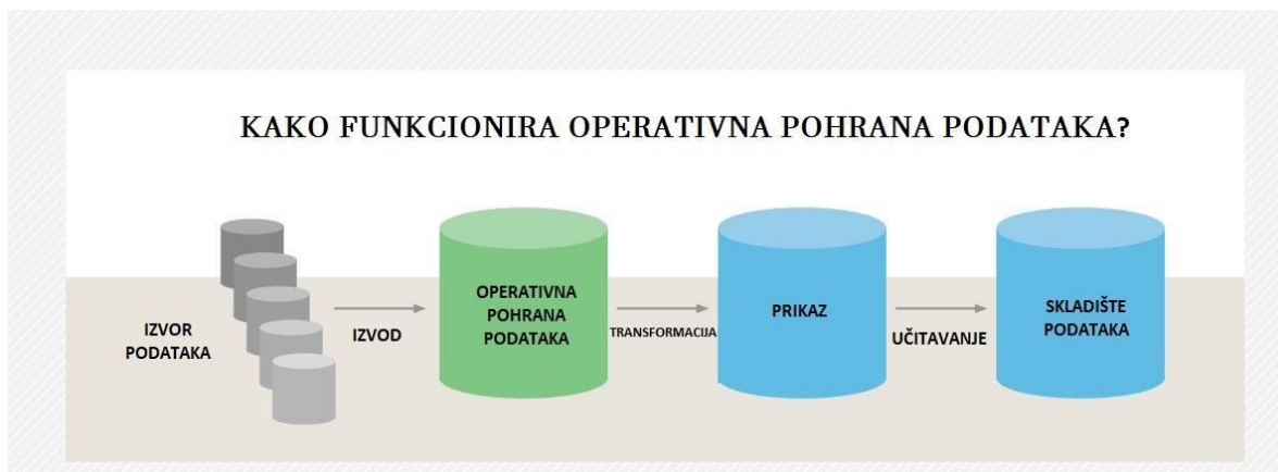
Slika 3. Način funkcioniranja operativne pohrane podataka [12]
