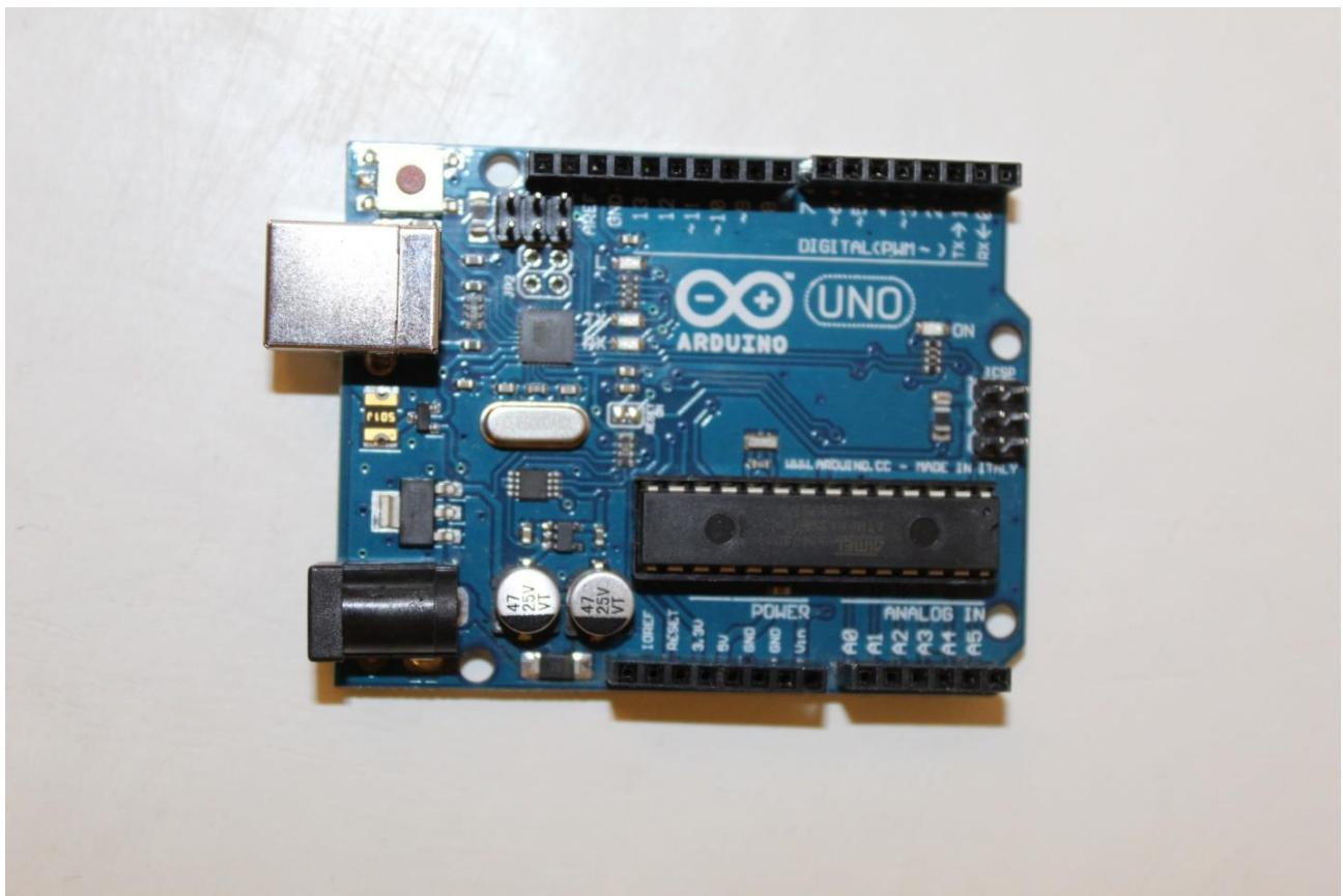
Slika 2. Predodžba mikro upravljača Arduino UNO.
