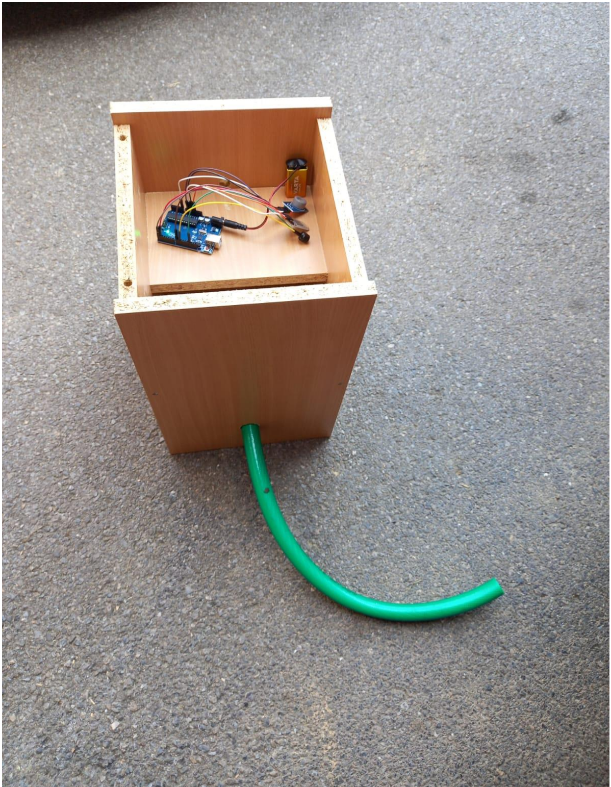
Slika 22. Predodžba postavljenog alarmnog sustava i kutije za ispitivanje.
