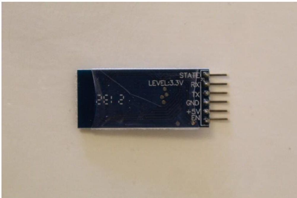
Slika 9. Predodžba prednje strane Bluetooth modula.
