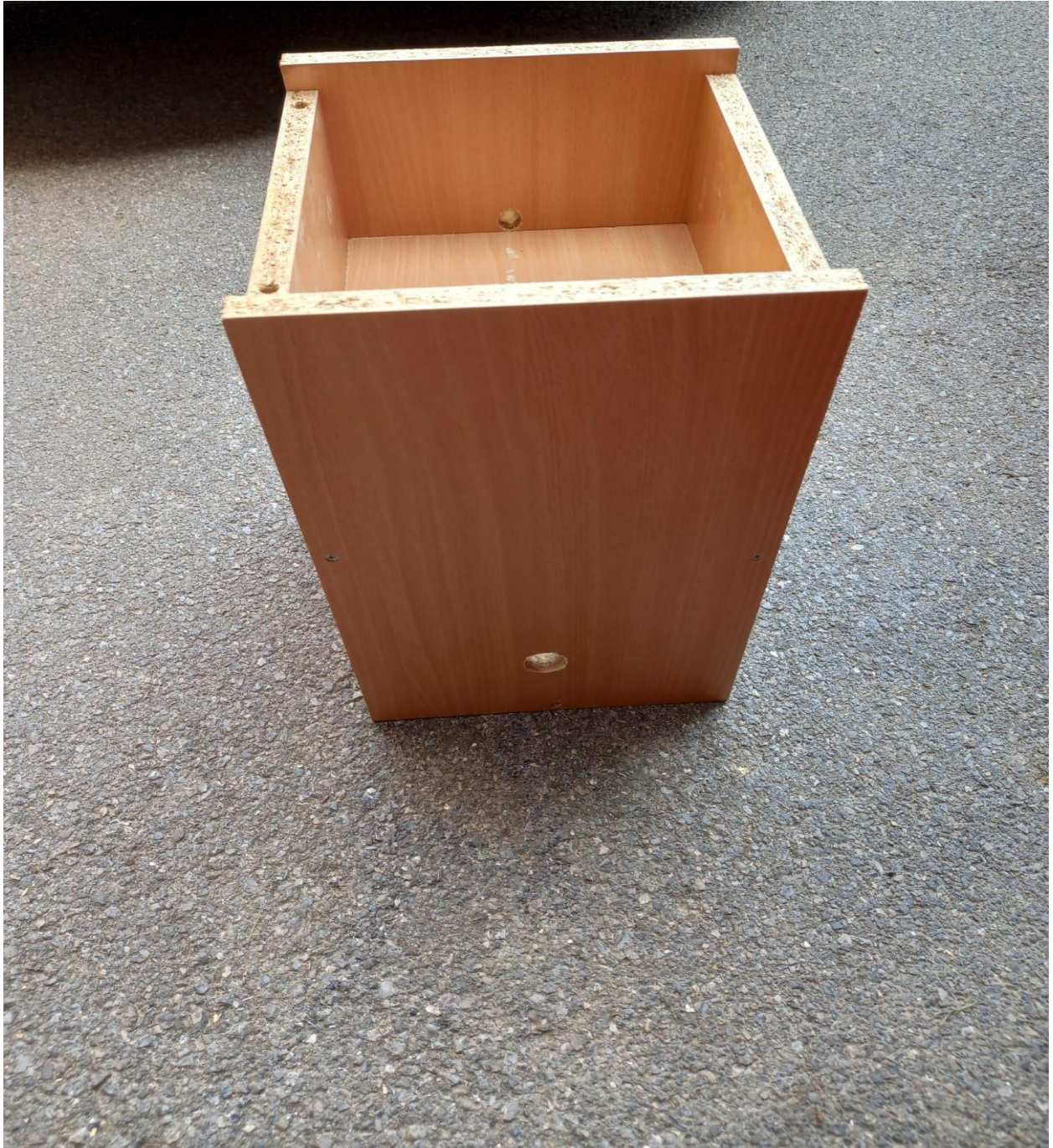
Slika 21. Predodžba kutije za ispitivanje alarma za ugljikov monoksid.
