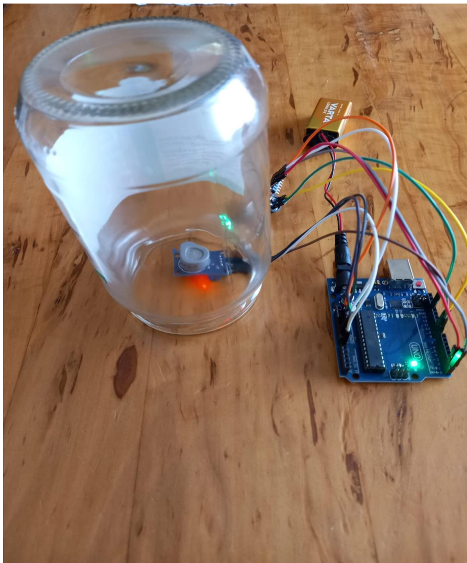
Slika 20. Predodžba ispitivanja alarmnog sustava u staklenoj boci.
