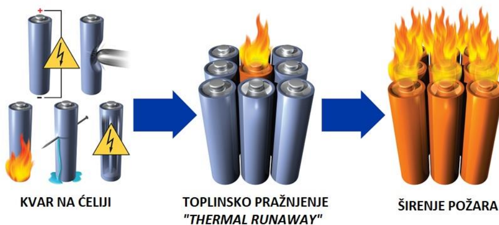
Slika 3. Širenje požara baterijskog modula [18]
