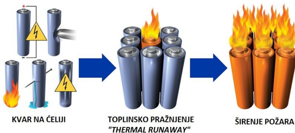
Slika 3. Širenje požara baterijskog modula [18]
