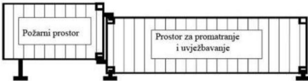
Slika 4.1. shema simulatora na kruta goriva [7]
