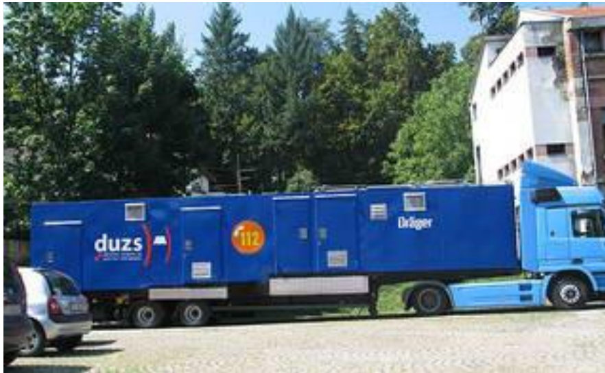
Slika 4.3. Mobilni simulator plamenih udara na kruta goriva [7]
