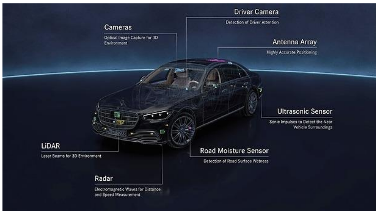
Slika 10. Senzori DrivePilot-a, Mercedes Benz S klasa, izvor [46]
