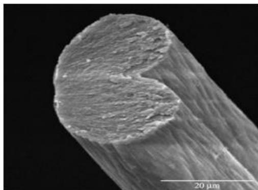
Slika 6. Izgled akrilnog vlakna pod mikroskopom
