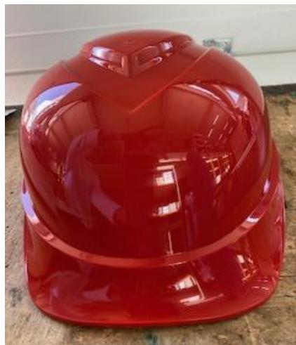
*Slika 14. Elektroizolacijska kaciga*
