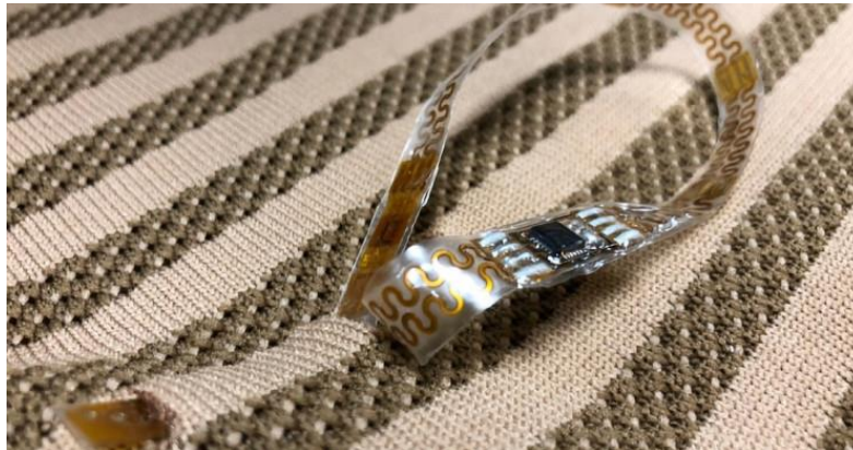
Slika 11. Perivi senzor koji prati vitalne znakove korisnika
