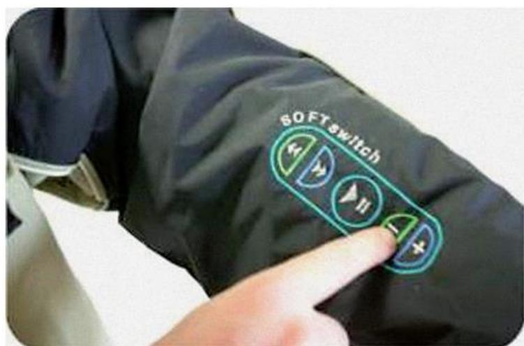
Slika 10. Vodljiva vlakna utkana u osnovni tekstilni materijal
