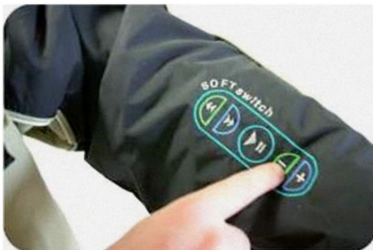
Slika 10. Vodljiva vlakna utkana u osnovni tekstilni materijal
