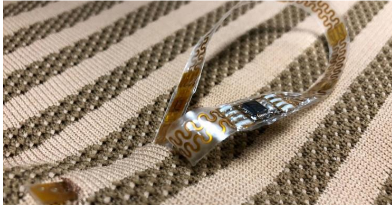
Slika 11. Perivi senzor koji prati vitalne znakove korisnika
