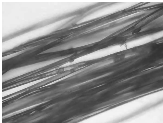
Slika 4. Izgled poliesterskog vlakna pod mikroskopom
