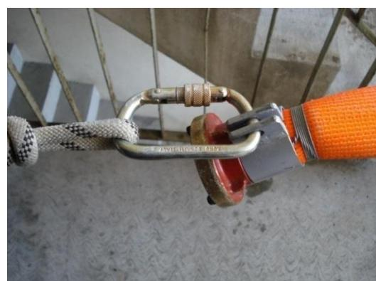
Sl.27. Vezivanje vertikale visokog tlaka
