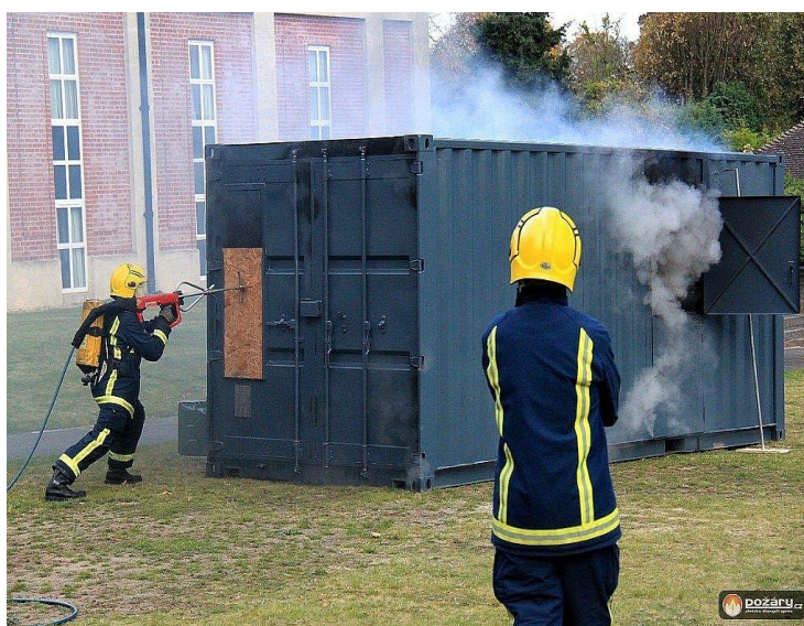
Sl. 36. Simulacija gašenja CCS Cobrom
