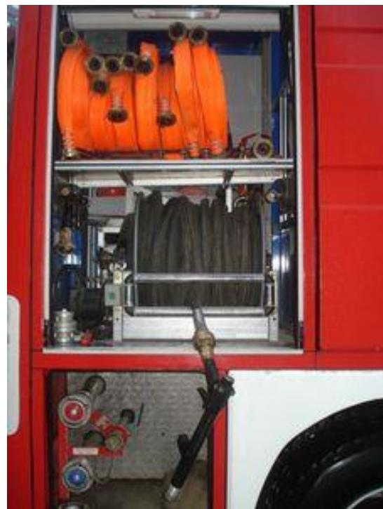
S1.18. Ugrađena oprema na vozilu za visoki tlak
