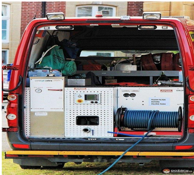
Sl. 37. Ugradnja CCS Cobra na vozilo
