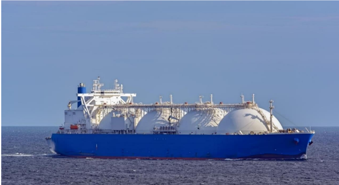
Slika 5. Tanker sa kuglastim spremnikom za prijevoz plina [9]
