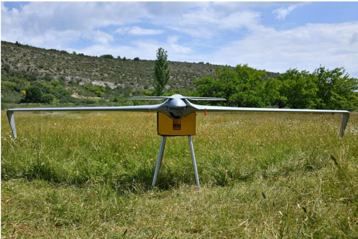
Sl. 8. Besposadni zrakoplovni sustav Orbiter 3
