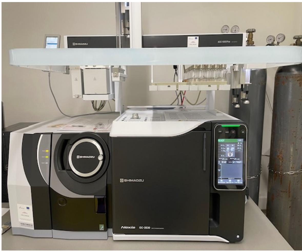
**Slika 7.** Plinski kromatograf Shimadzu Nexis GC-2030
