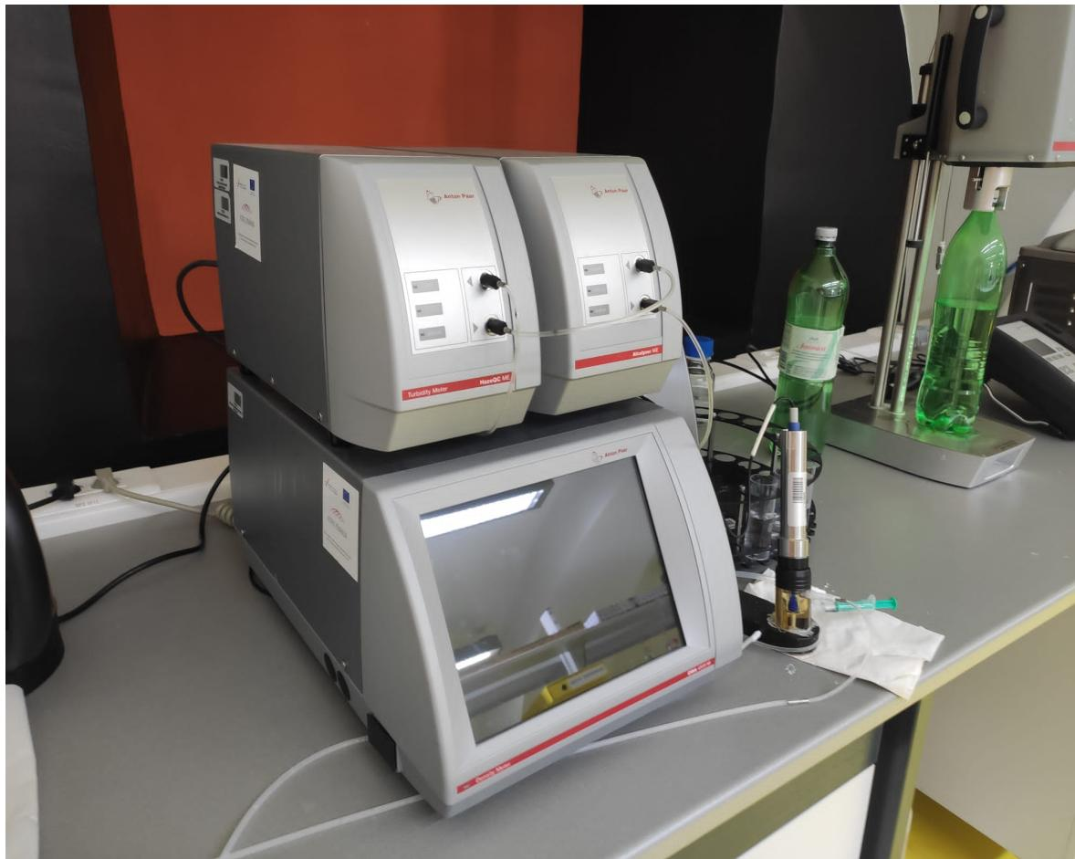
**Slika 5.** Anton Paar analizator DMA 4500 M
