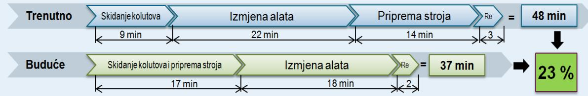
Slika 15 Skraćenje vremena izmjene alata za oba radnika [11]
